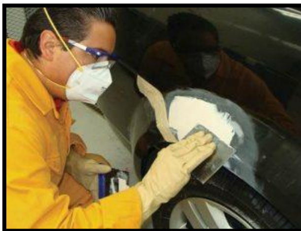
Figura 20.- Limado Y Observado A 30° Fuente: (Castillo Automoción, 2014)
