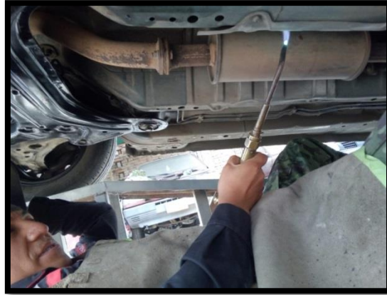
Figura 25. Soldado De Fisuras
