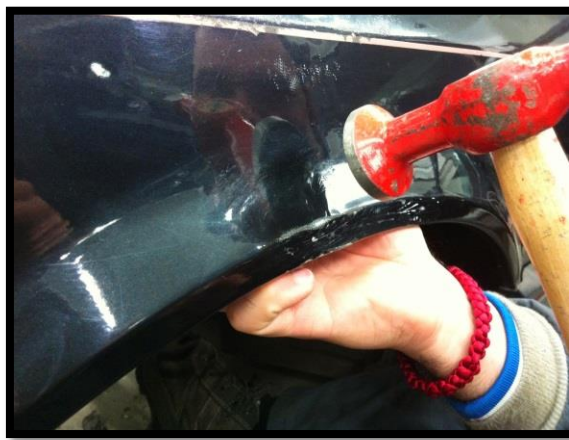
Figura 19. Utilización Martillo Y Tas Fuente: (Castillo Automoción, 2014)
