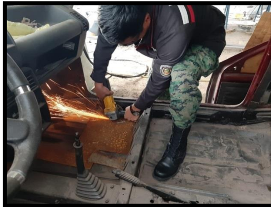
Figura 34. Corte Del Piso Con Amoladora
