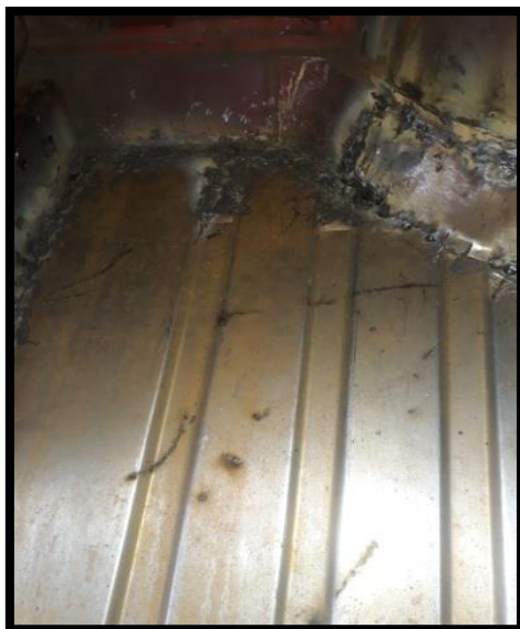
Figura 37. Lijado Del Piso
