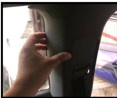
Figura 31.- Cubierta Del Cinturón
