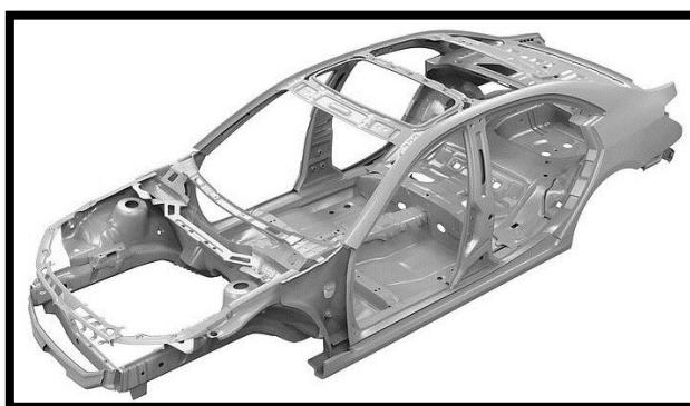
Figura 3. Carrocería monocasco Fuente: (blog reparación vehículos, 2014)
