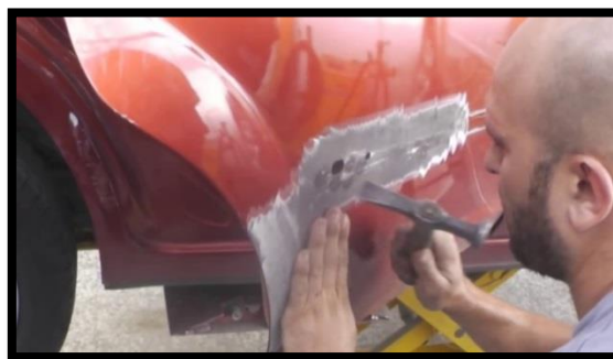
Figura 17. Contracción De Abolladura Fuente: (Cesvimap, 2017)
