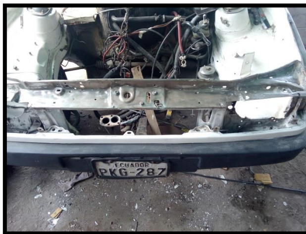
Figura 22.- Desmontaje Del Motor
