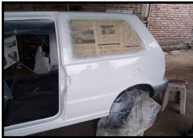
Figura 67.- Desmontaje De Puertas Y Pintado
