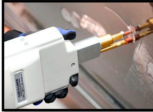
Figura 16. Pistola Extractora Fuente: (Car-O-Liner, 2019)
