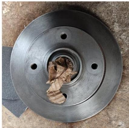
Una vez lijados los discos se procede a pasar una capa de spray de frenos sobre todo el cuerpo del disco de frenos para quitar el óxido. Dejar reposar por 15 minutos hasta que el spray surja efecto, en caso de que el óxido persista se debe volver a mandar otra mano de spray de freno.
