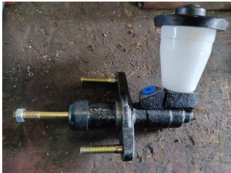
**2.6.2.2. Cilindro Maestro con Doble Cámara.** Construido con dos émbolos o pistones, que al presionar el pedal de frenos se accionan al mismo tiempo, en este tipo de diseño el líquido hidráulico es enviado por igual al cilindro delantero y trasero de forma independiente. Durante su accionamiento a la presión se mantiene y cuando la acción de frenado termina un muelle de recuperación en el interior del cilindro maestro retorna los émbolos a su posición de partida.
