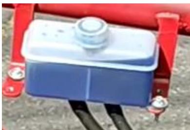
Depósito dispuesto de dos cañerías que reparte líquido a cada una de las cámaras del cilindro maestro o bomba de frenos.
