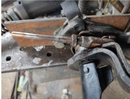
Cuando la bomba de freno y la pedalera queden alineadas se procede a soldar las bases.
