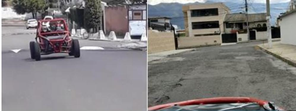
Se realizó una prueba de ruta con el fin de verificar el funcionamiento de los frenos para ello se trazó un recorrido de 3 km a diferentes velocidades siguiendo los puntos de la figura 71.
