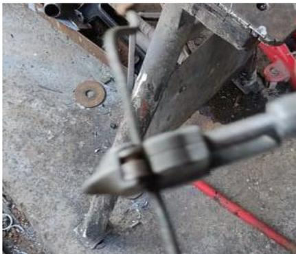
Para realizar la boca de las cañerías con las que serán sujetas los racores se usó un abocardador.
