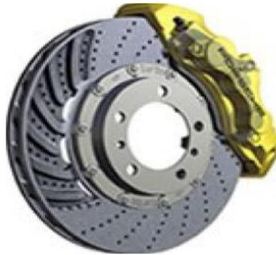
*Nota.* El disco de cerámica como se puede observar en la figura está compuesto entradas de aire similares a las del discos perforados y estriados. Tomado de (Cáraces Gavilanez & Ruiz Solórzano, 2015)
