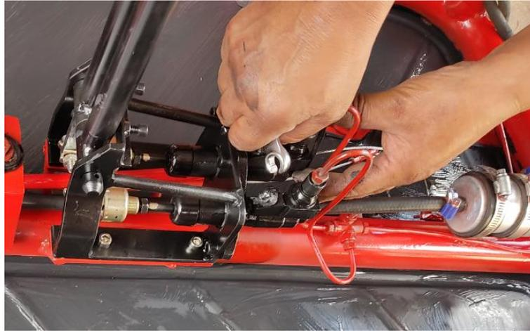
Realizada nuevamente la inspección del sistema hidráulico, se determinó que no existían fugas en las cañerías y acoples de los frenos delanteros, por consiguiente, se comprobó el funcionamiento del émbolo interior situado en la mordaza de freno, para ello se pisa el pedal de freno y la pastilla debe chocar con el disco de freno. En caso de que no sucede significa que el pistón se encuentra agarrotado al cilindro por ende se procedería a su respectiva reparación.
