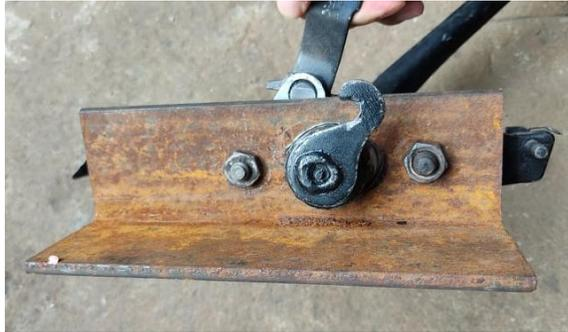
Para la base de la bomba hay que centrar la base de la pedalera de tal forma que el barilla de accionamiento del freno(macho) quede centrada con la bomba además se marcan los puntos de perforación.
