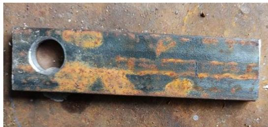
En el eje de accionamiento(macho) se procedió a soldar un bulón de una 1 in para que la pedallera tenga mejor distancia de acción entre el pedal y el pie del conductor.
