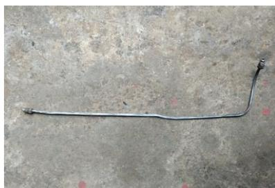
Para la conexión hidráulica de sistema de frenos se usó cañerías solidas de acero además de latiguillos en lugares de difícil conexión.
