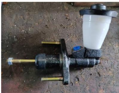
Se usarán dos bombas de embrague conectadas por medio de una válvula repartidora a una de las salidas o pasos del cilindro maestro, además estas servirán como un cilindro de paso directo de fluido.
