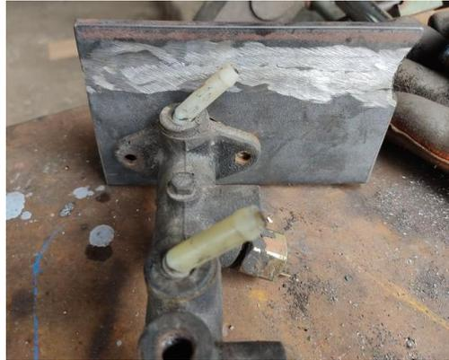
La base de la pedallera necesita de una platina refuerzo para su sujeción al piso del vehículo buggy. De igual forma se procede a cortar una platina de acero de 91 x 25 mm con una perforación de diámetro 14 mm (9/16).
