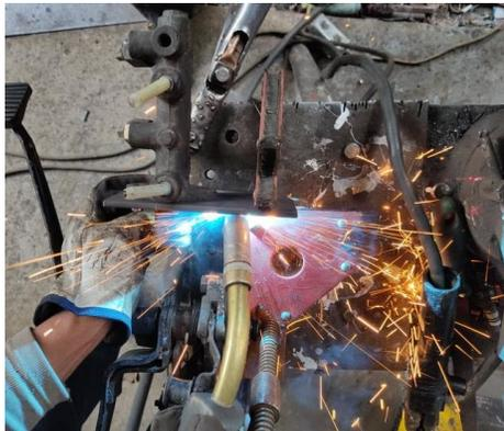
Como se mencionó anteriormente la base quedará configurada de tal forma que el cilindro maestro quede por encima del chasis tubular para ello con ayuda de platinas dispuestas por debajo del piso del buggy se procederá a su ajuste.
