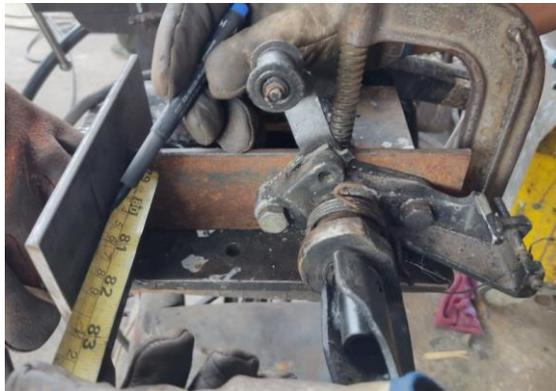
Se perfora una circunferencia de diámetro 44 mm (1  $\frac{3}{4}$  in), y con una broca 9/16 para los pernos de sujeción. Una vez perforada la platina se monta la bomba de freno y se ajustan los pernos.
