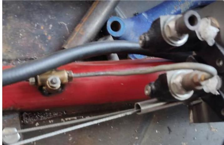
Con cañería solida se conectan cada paso de las dos bombas de freno hacia cada una de las ruedas traseras de tal forma que el caudal generado sea constante.
