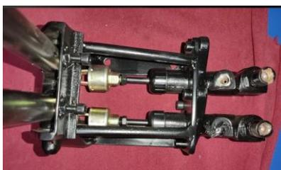
El freno de mano consta de dos palancas mecánicas que accionan una bomba de embrague cada una.
