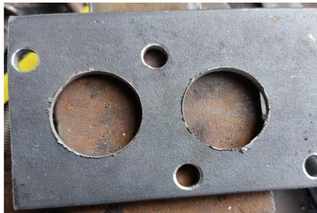
En las dos platinas de 130 x 30 mm, se perfora una circunferencia con una broca 7/8 y con una prensa hidráulica se dobla el centro de la platina en diagonal.
