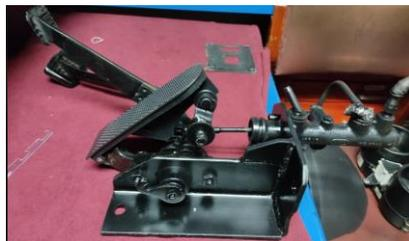
Se uso la pedalera del Volkswagen Brasilia con la adaptación de una base hecha de platinas para el correcto anclaje y ubicación de la bomba de frenos.
