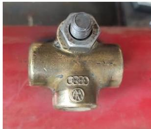
Válvula dispuesta en cada salida independiente de la bomba de frenos para la repartición de líquido de frenos a cada cilindro de rueda trasero del prototipo buggy.
