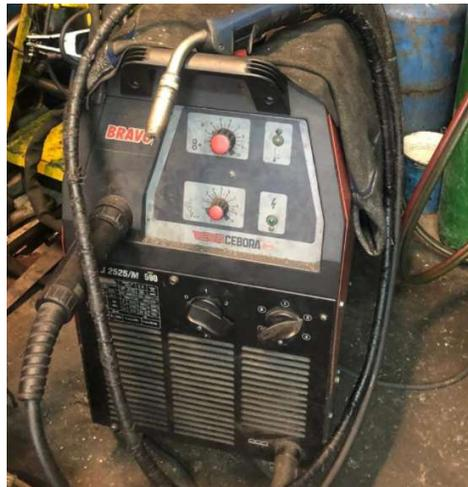
*Nota:* Soldadora de método GMAW (MIG), la cual se utilizó para el proceso de soldadura de estructura del bastidor
