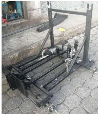
*Nota.* Bastidor construido los puntos de apoyo de tracción y herramientas.
