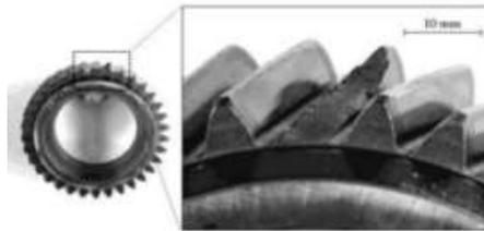
*Nota:* ruptura de diente de un piñón por fatiga de material, (Estrada, 2015).
