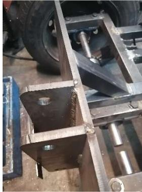
*Nota.* Construcción de soporte herramientas y tracción formando un solo conjunto en el bastidor.
