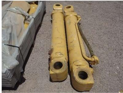
*Nota:* Cilindros de cargadora de una retroexcavadora, (Maquinaria WIEBE, 2014).
