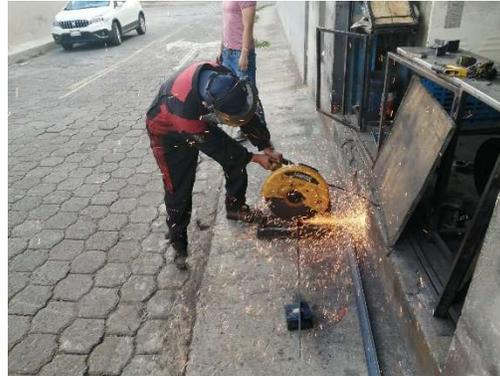
*Nota.* Los puntos de apoyo del motor de combustión interna fueron contruidos de perfiles tipo C de medidas 80mmx40mmx2.5 mm
