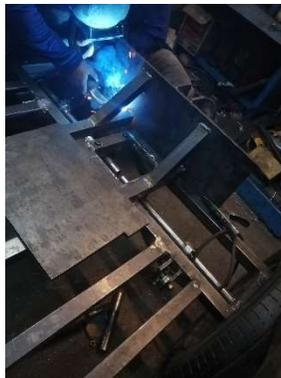
*Nota.* El conjunto solido fijado a la placa de 10 mm previamente acoplada al bastidor tiene la función de acoplar el conjunto de pluma cucharón mediante pasadores de acero de diámetro 22mm, formando un solo cuerpo en el bastidor.
