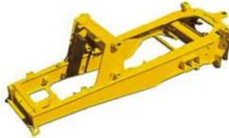
*Nota:* Bastidor sólido d retroexcavadora, (MAQPE.COM, s.f.).
