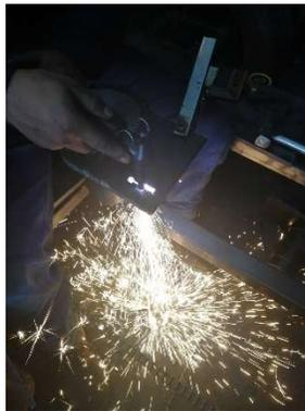
*Nota.* Consta de dos etapas en la primera, el acero se calienta a alta temperatura (900 °C) con la llama producida por el oxígeno y un gas combustible; en la segunda, una corriente de oxígeno corta el metal y elimina los óxidos de hierro producidos.
