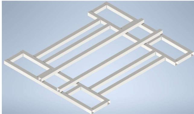
*Nota.* Miembro estructural de bastidor inferior armado y soldado en la software de paoyo inventor.
