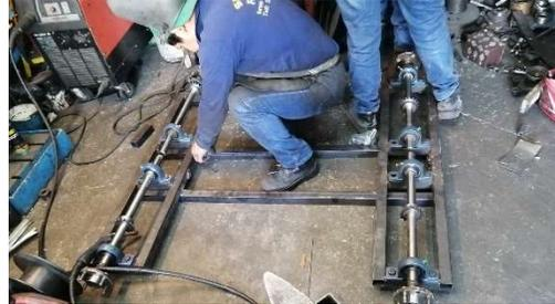
*Nota.* La parte inferior del bastidor es el punto de ensamble para la tracción del banco de entrenamiento de maquinaria pesada.
