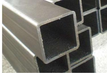
*Nota:* ACERO ASTM36 para construcción estructural (DIPAC Productos de acero, 2016)
