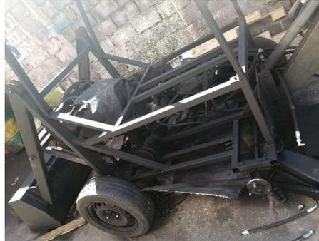
*Nota.* Proceso de manufactura terminado y ensamblado componentes hidráulicos del banco de entrenamiento de maquinaria pesada.
