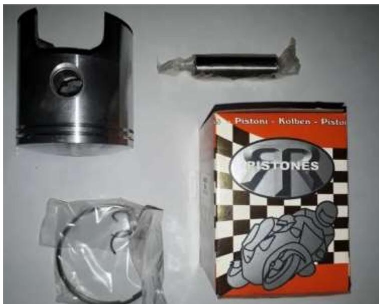
*Nota.* Podemos apreciar un quit de reparación de un motor de moto.
