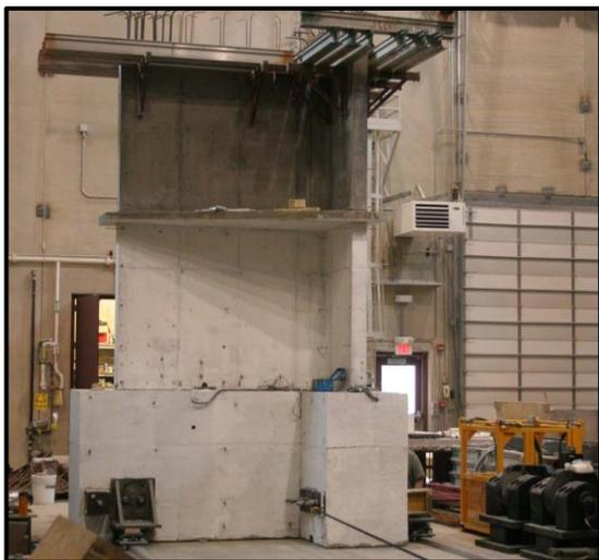
**(b)** Ensamblaje de muro T (especimen NTW2)
