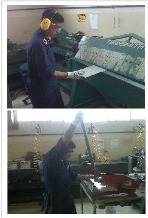
Fig. 3.24 Corte y Doblado de la lámina
