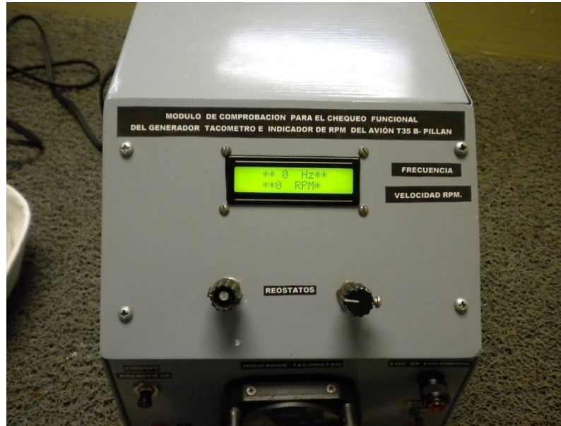
Fig. 3.33 Funcionamiento del Módulo de Comprobación
