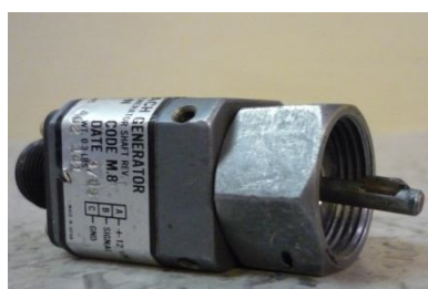
Fig. 4.2: Generador Tacómetro Fuente: Investigación de campo Realizado por: Cbos. Vera Juan
