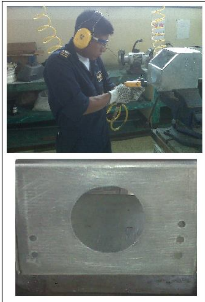
Figura 3.25 Aberturas en la Estructura
