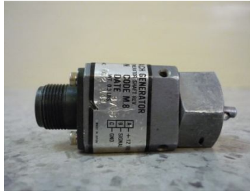
Fig. 2.15. Generador Tacómetro Fuente: Investigación de Campo Realizado por: Cbos. Vera Juan
