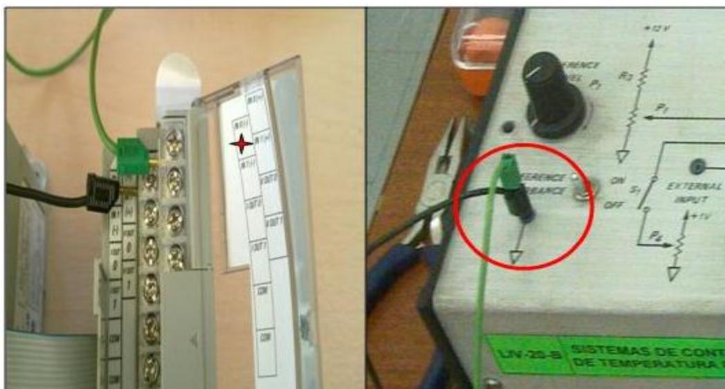
**Fotografía 3. 7** Conexión entre la IN 0 (-) y el punto de referencia del módulo.
