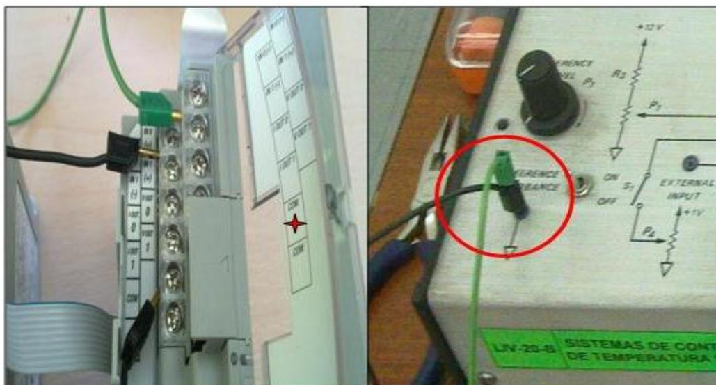
**Fotografía 3. 8** Conexión a la entrada COM, y el punto de referencia del módulo.
