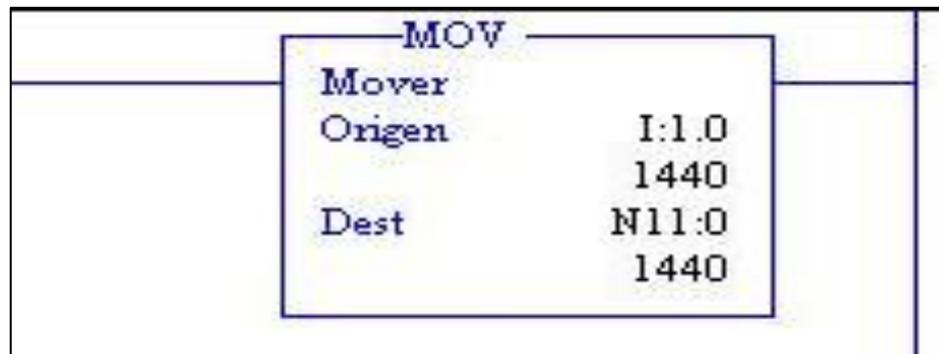
**Figura 3. 19** Ajuste de valores en la instrucción MOV.
