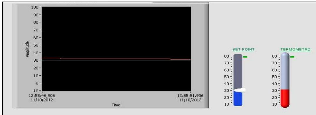
**Figura 3. 78** Visualización de la temperatura del flujo de aire en el HMI.
