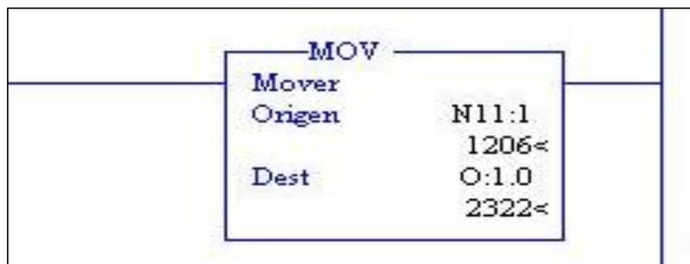
**Figura 3. 20** Ajuste de valores en la instrucción MOV.
