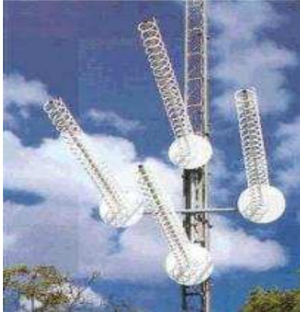
Fig. 2.1.18: Antenas helicoidales.
