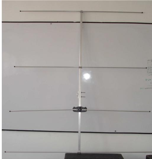
Foto. 3.7. Antena receptora de señales FM en el rango 87,5 – 108Mhz
