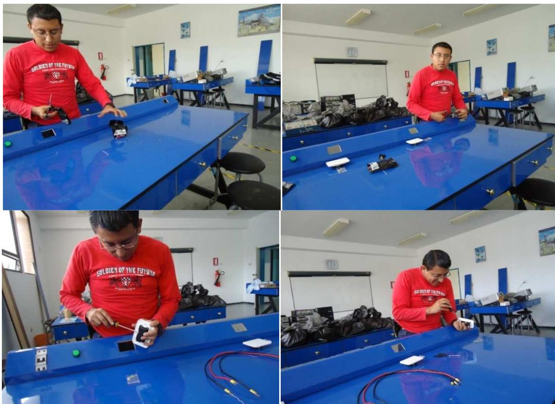
Foto 3. 14 Se retira las fundas de protección y se aflojan los tornillos de los tomacorrientes
