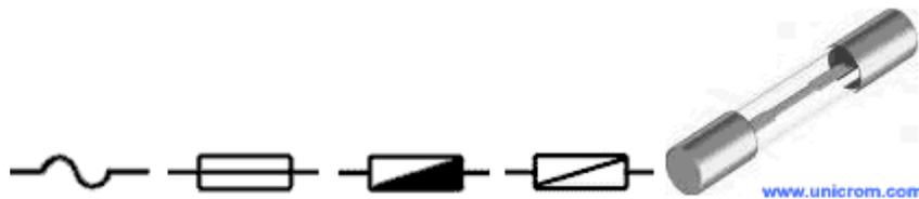
Fig.2. 1 Representación de un fusible.
