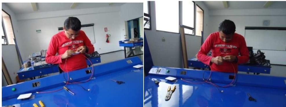
Foto 3. 16 Colocación y ajuste del cable de color negro (Neutro)
