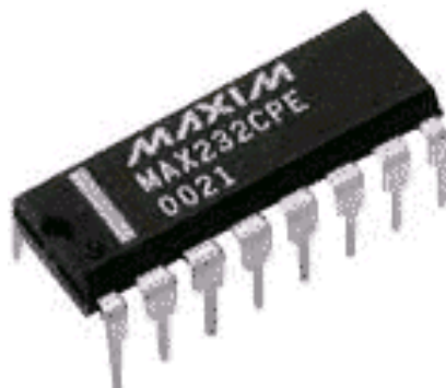
Figura 2.13. Forma física MAX 232
