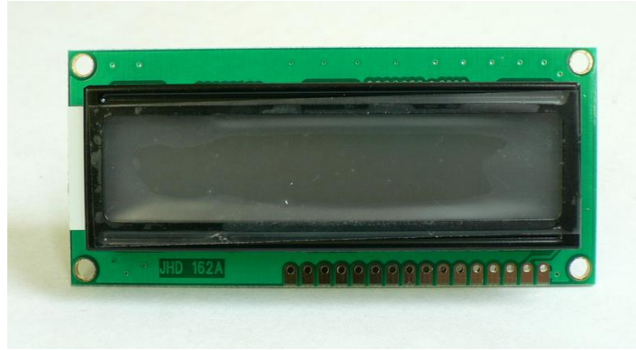
Figura 2.27. Forma física de display 2x16 Fuente: http://www.pablin.com.ar/electron/info/lcd/index.htm
