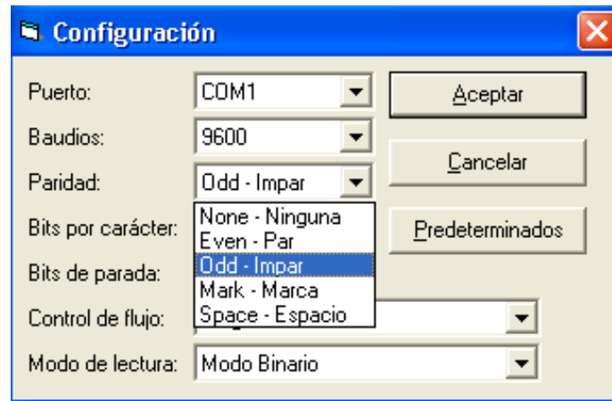
Figura 3.21. Ventana de configuración de parámetros programa VISUAL BASIC Fuente: Fuente: Cristian P. López E.
