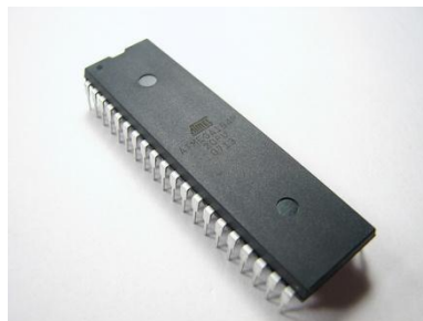
Figura 2.20. Forma física del ATMEGA 164P
