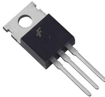
Figura 2.7. Forma física del TIP 127
