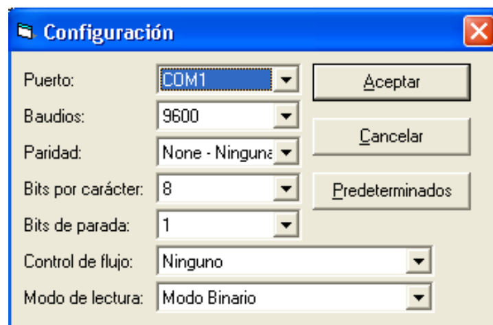
Figura 3.18. Ventana de configuración de parámetros programa VISUAL BASIC Fuente: Fuente: Cristian P. López E.
