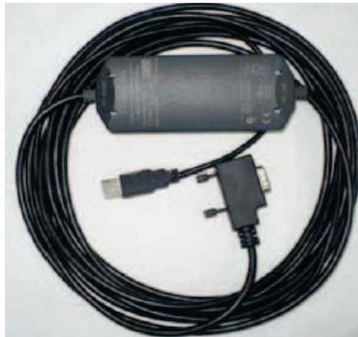
Figura 4.8. Cable de comunicación PPI
