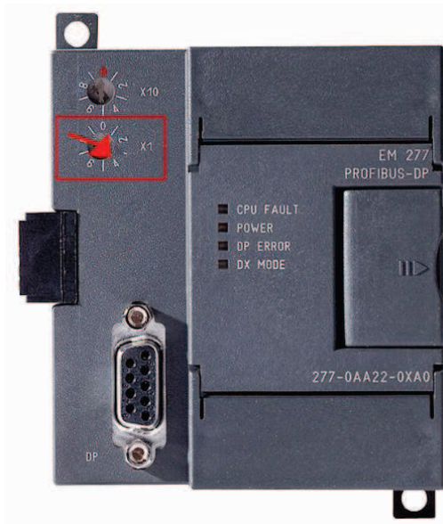
Figura 3.32. Direccionamiento de la estación del módulo EM 277. Fuente: Módulo de comunicación Profibus DP EM 277.
