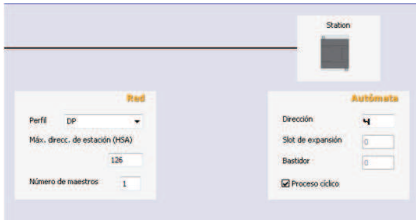
Figura 3.23. Configuración adicional de comunicación Profibus DP. Fuente: Software WinCC Flexible Advanced 2008 Elaborado por: Francisco Ganchala
