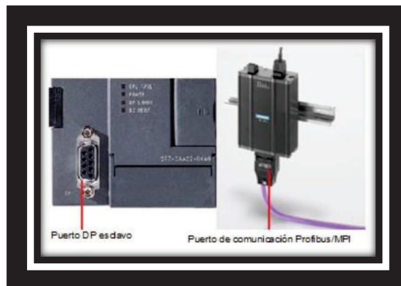
Figura 3.35. Puertos de conexión del módulo EM 277 y el CP 5711. Fuente: pfc2826.pdf Paint. Elaborado por: Francisco Ganchala
