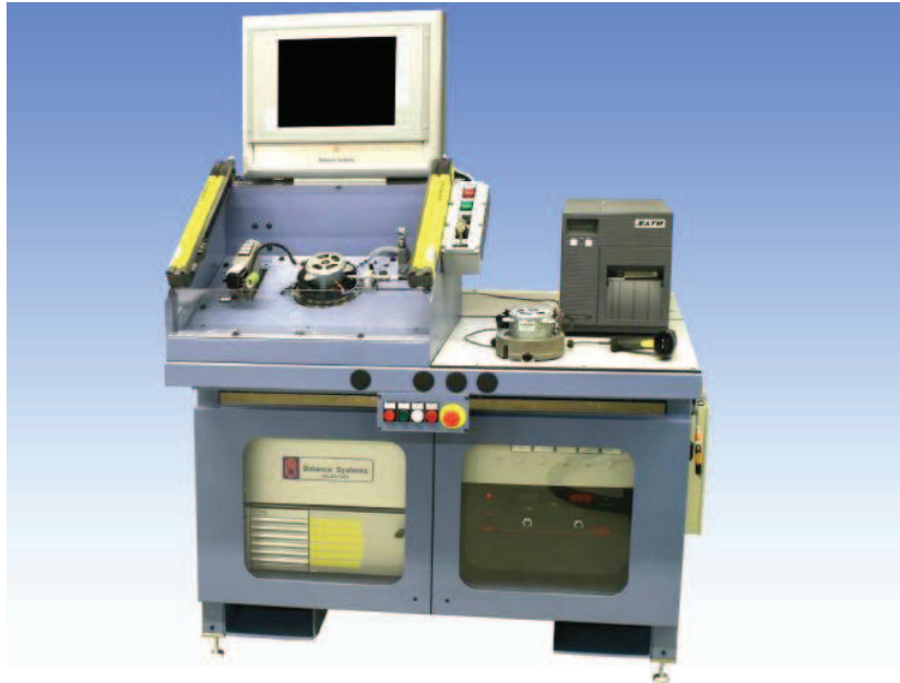
Figura 3.4. Ejemplo de banco de pruebas para motores Fuente: Banco BTM5, Balance Systems S.R.L.
