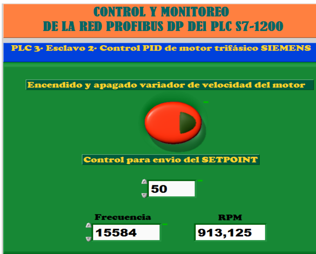
Figura 3.96 Consola HMI para el control y monitoreo del control PID de motor trifásico SIEMENS, controlado por PLC 3 –ESCLAVO 2 de la red Profibus DP de PLC S7-1200
