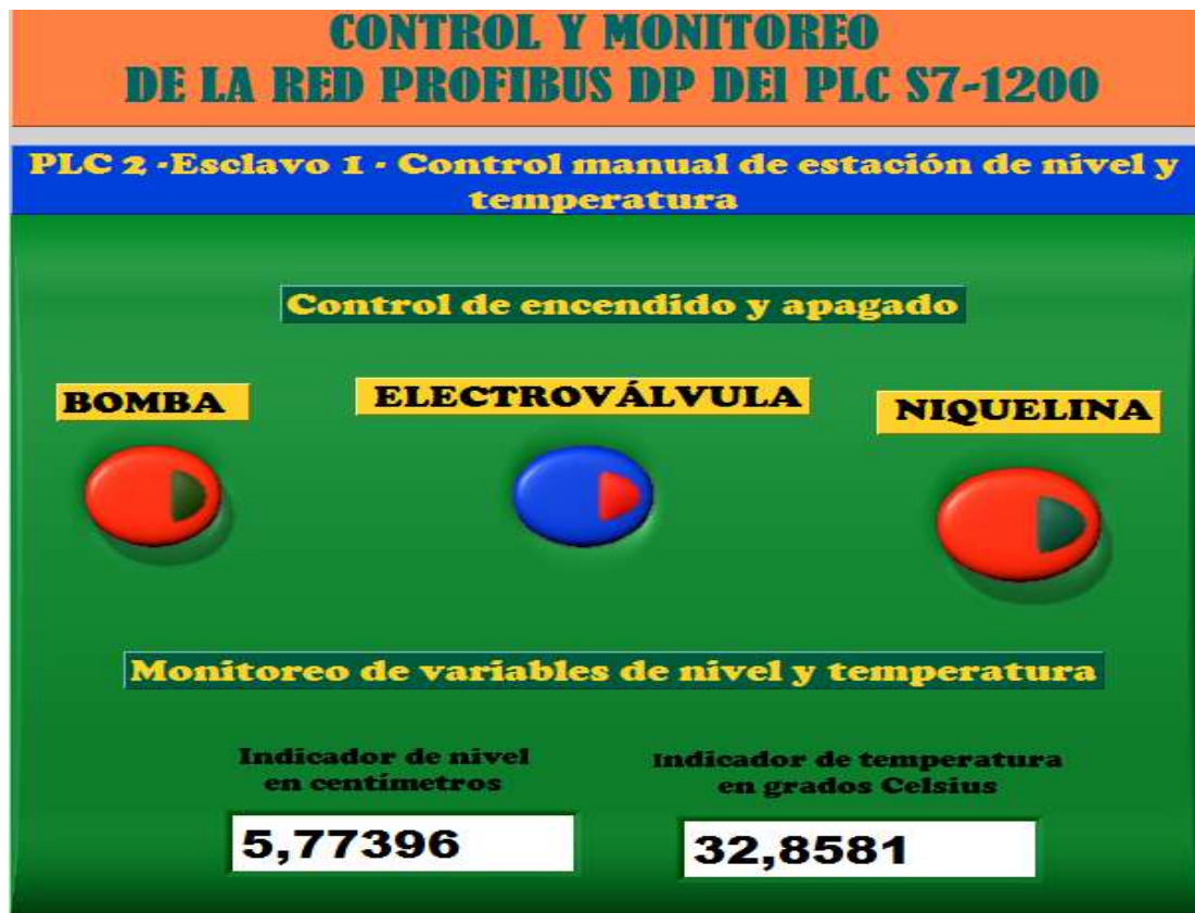
Figura 3.56 Consola HMI para el control y monitoreo de la estación de nivel y temperatura de líquido, controlada por el PLC 2-ESCLAVO 1 de la red Profibus DP con PLC S7-1200
