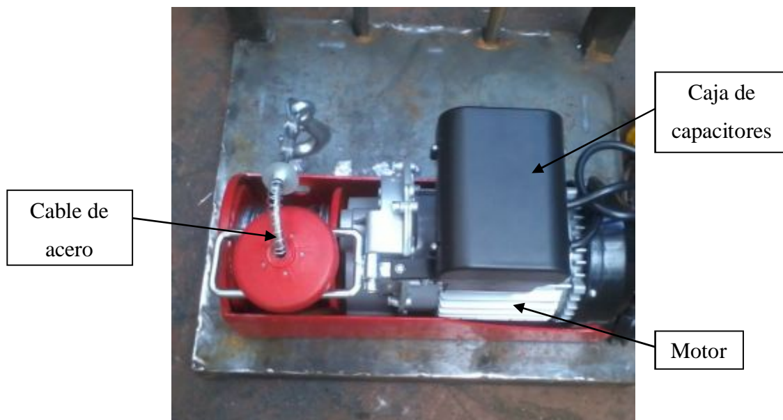
Figura 64: Montaje del motor monofásico asíncrono
