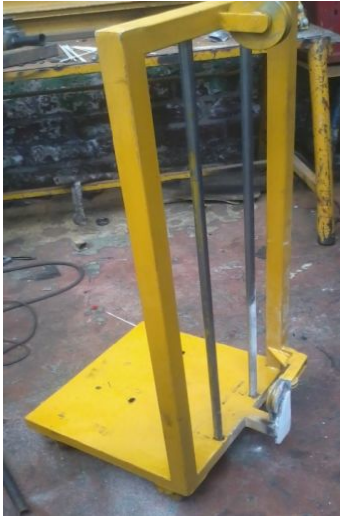
Figura 63: Montaje de las poleas
