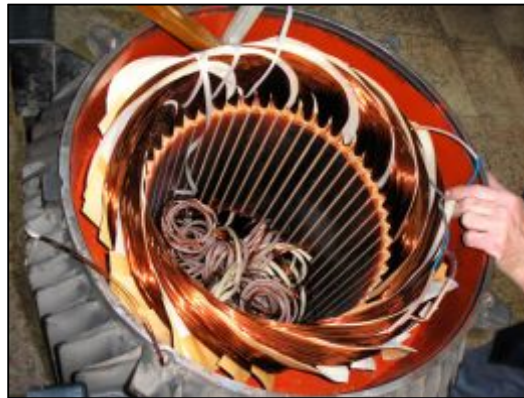
Figura 7: Bobinado de un motor eléctrico
