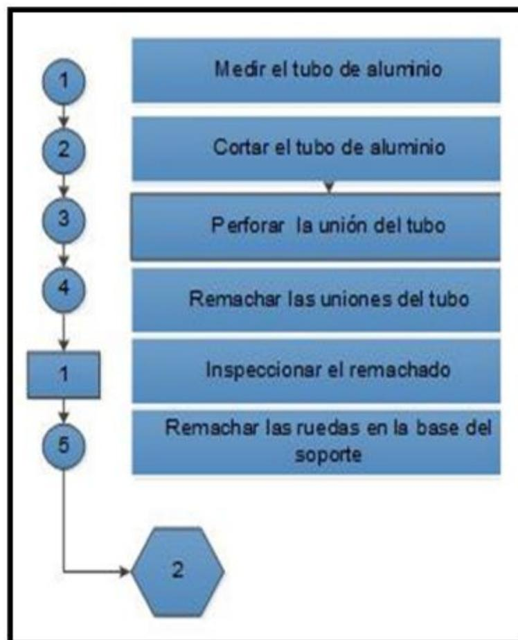
**Figura 33.** Diagrama de construcción del soporte del módulo didáctico
