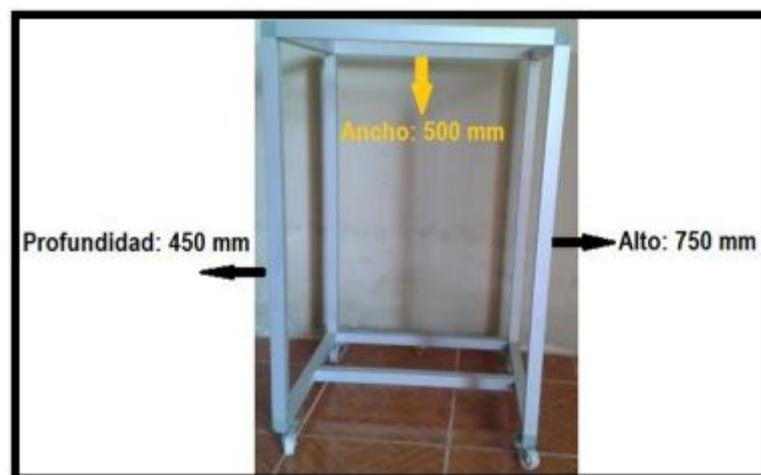
**Figura 38.** Medidas del soporte del módulo
