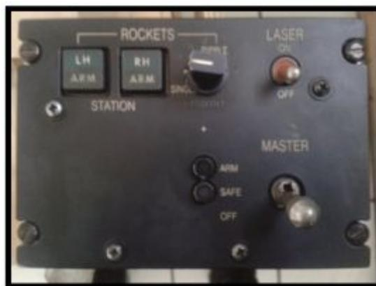
**Figura 9.** Caja de control de armamento
