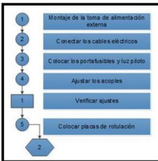
Figura 35. Diagrama de ensamblaje del arnés de conexión eléctrico
