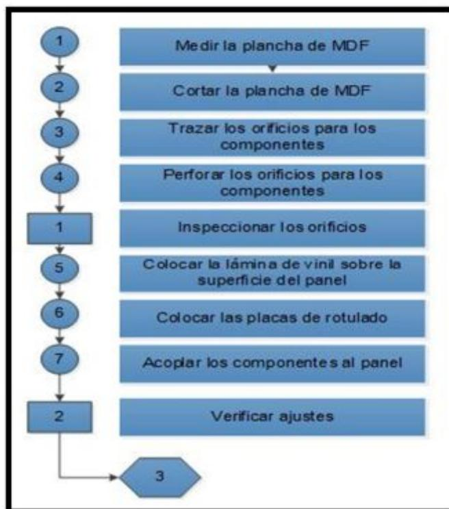
Figura 34. Diagrama de construcción del panel de control del módulo
