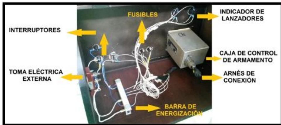
**Figura 53.** Conexión del sistema eléctrico
