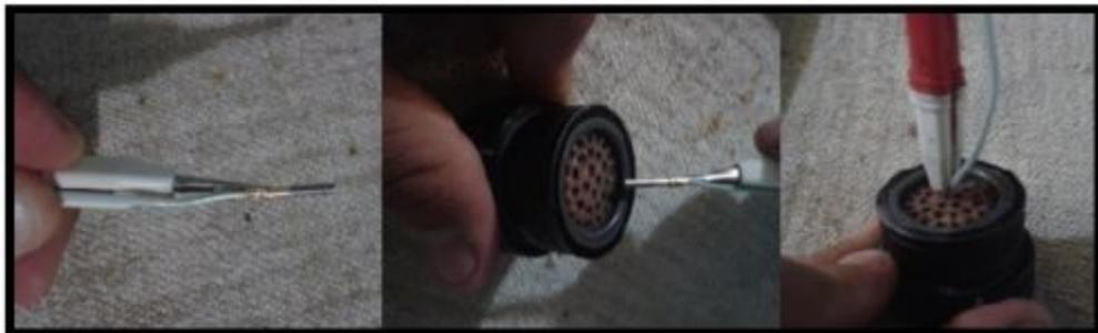
**Figura 48.** Proceso de inserción de los pines en el conector
