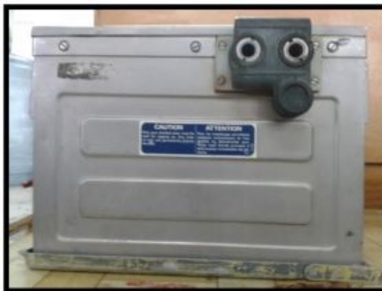
**Figura 4.** Batería níquel cadmio
