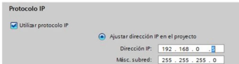
**FIGURA 124: Ajuste de la dirección IP del HMI.**
