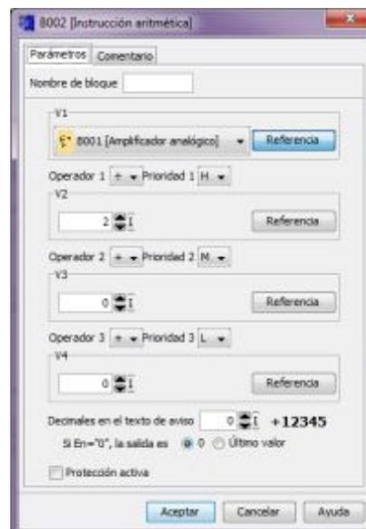
**FIGURA 105: Configuración de la instrucción aritmética.**
