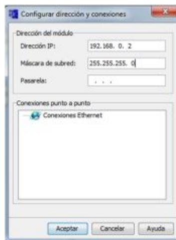
**FIGURA 111: Ventana configurar dirección y conexiones.**
