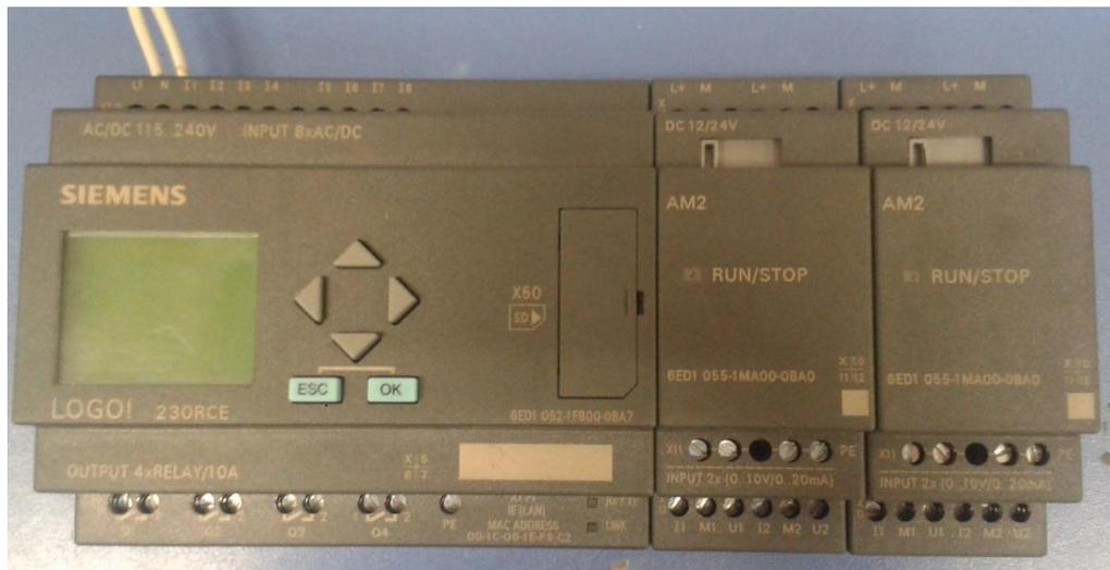
**Figura 83:** Conexión física de 2 Módulos AM2 al LOGO! 230 RCE.
