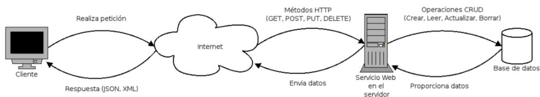
*Nota.* Arquitectura cliente-servidor donde se puede ver el funcionamiento del servicio web Rest. Tomado de (PEREZ TIRZO, 2018)
