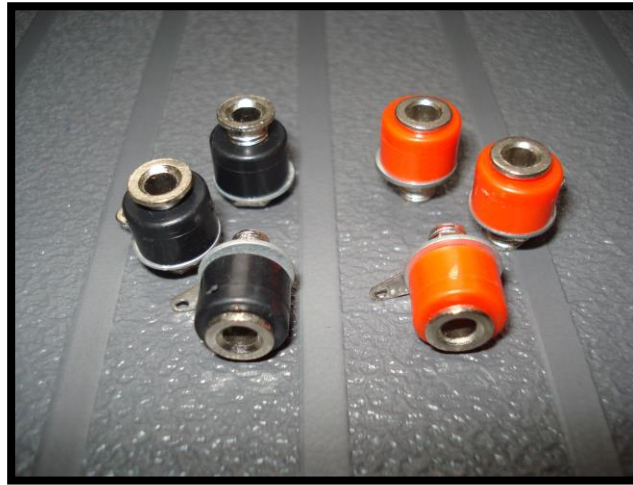
Foto. 6.6 Jacks de alimentación Fuente: Módulo para motores de AC Elaborado por: Cbos. Benavides Holger
