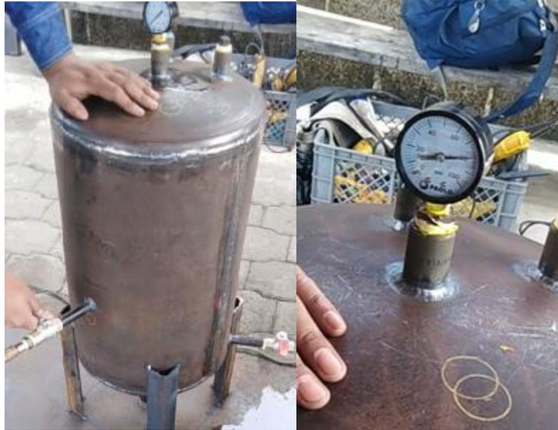
Concluida la prueba hidrostática, al no tener fugas de presión, se procedio a soldadar los soportes del aislante térmico y se instaló una carcasa externa de aluminio.
