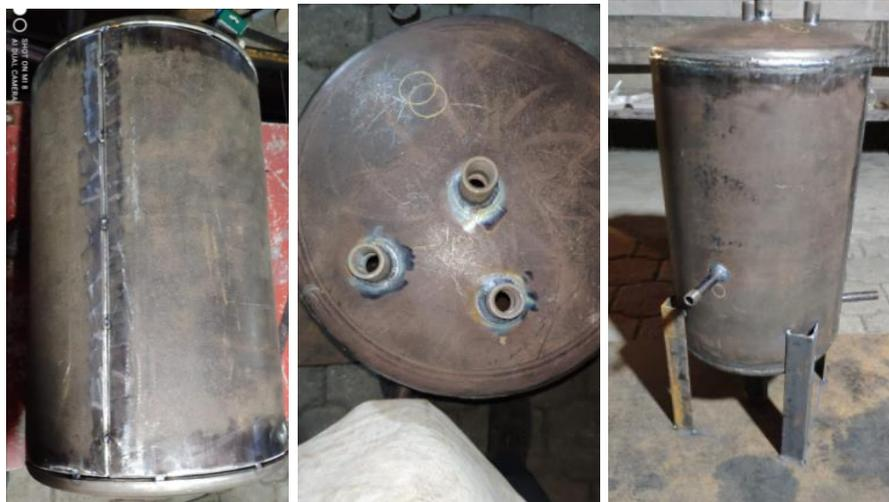
Concluido el proceso de soldadura se realizó una prueba hidrostática para detectar posibles fugas de presión, la prueba hidrostática se realizó a una presión de 80 psi muy superior a la presión de funcionamiento del caldero de 30 psi.
