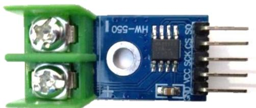
El módulo puede adaptarse a los microcontroladores Arduino mediante una conexión SPI (Serial Peripheral Interface), de bajo costo, su función es acondicionar una señal analógica de una termocupla a una señal digital, el rango de medida es de 0 a 1024 grados centígrados, tiene una resolución de 12 bits, 0,25 grados centígrados de apreciación, el tiempo de conversión máximo es de 0,22 segundos y su temperatura de trabajo se encuentra entre -20°C a 85°C.
