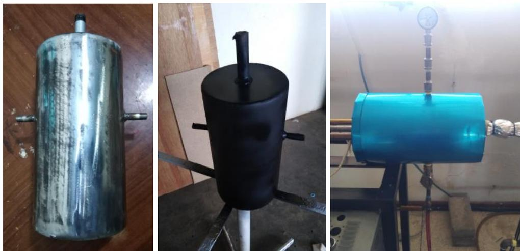
Las barras de sección circular fueron roscadas en la punta, para introducirlas dentro del reservorio de vapor, posteriormente, se realizó perforaciones de 2 mm de diámetro para insertar las termocuplas.
