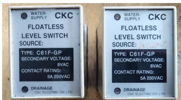
El interruptor de nivel C61F-GP cuenta con 8 terminales, para alimentación del mismo, una conexión de las líneas que miden el nivel de líquido y un contacto abierto o cerrado para instalar una bomba de agua.
