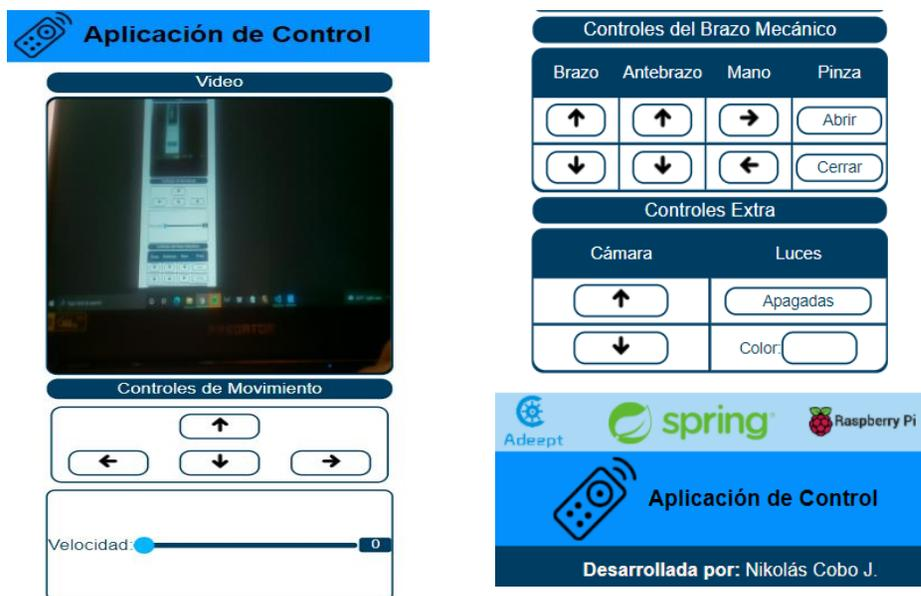
Como se pudo observar hay 4 componentes diferentes, el primero es el recuadro del video que trasmirá el robot, el segundo son los controles de movimiento del robot, el tercero, son los controles del brazo mecánico del robot y el cuarto son los controles extra del robot, como por ejemplo sus luces. Adicionalmente existe un componente que no es visible en la ventana principal y es debido a que es él que gestiona las alertas en el frontend, dependiendo de la respuesta del robot y del backend.
