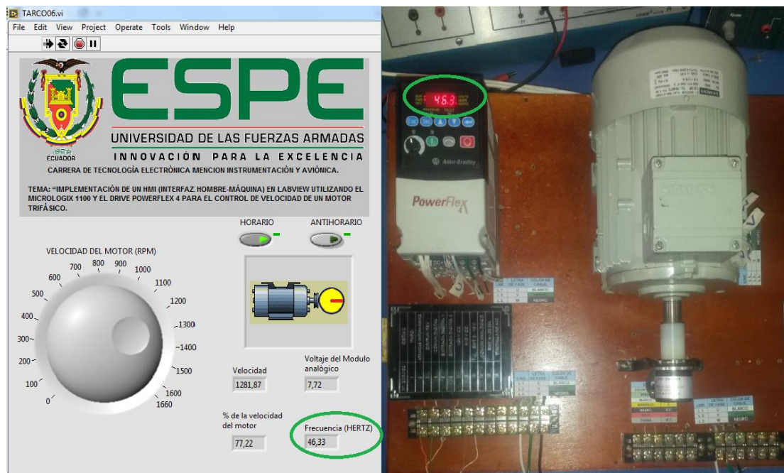
Figura 111: Frecuencia en el Labview y en el PowerFlex 4.
