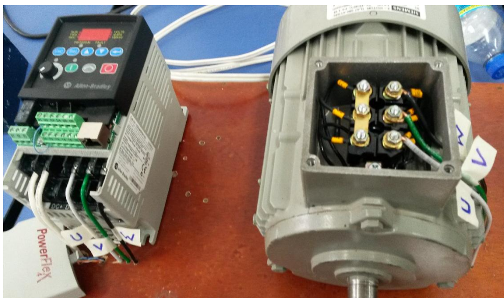
Figura 24. Conexión física de las tres fases.
