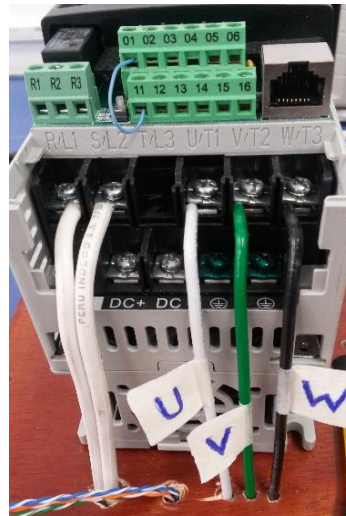
Figura 23. Conexión física de las tres fases del PowerFlex 4.
