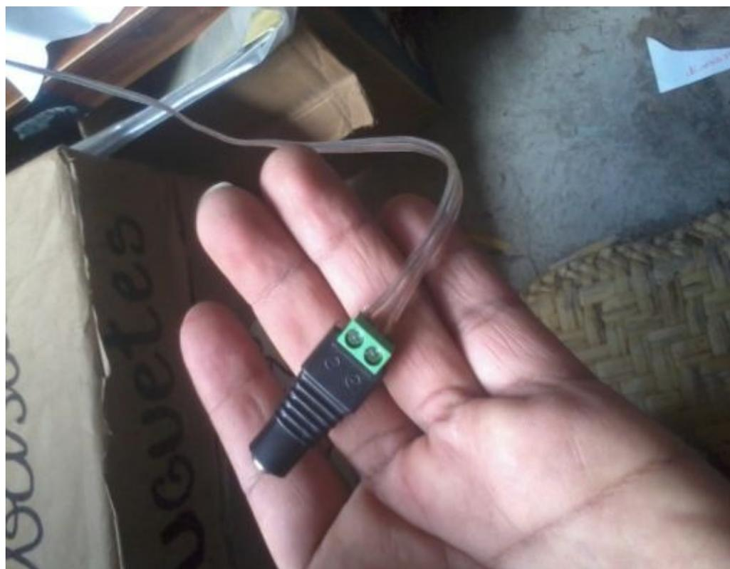
**Figura 60.-** Cable de Alimentación de la Cámara.
