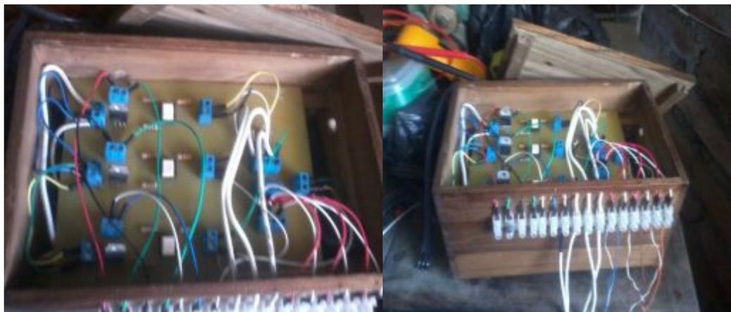
**Figura 91.-** Circuito de Control de Potencia y Señal.
