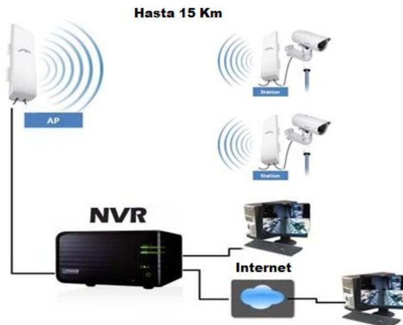
**Figura 22.-** Conexión Punto a Punto.
