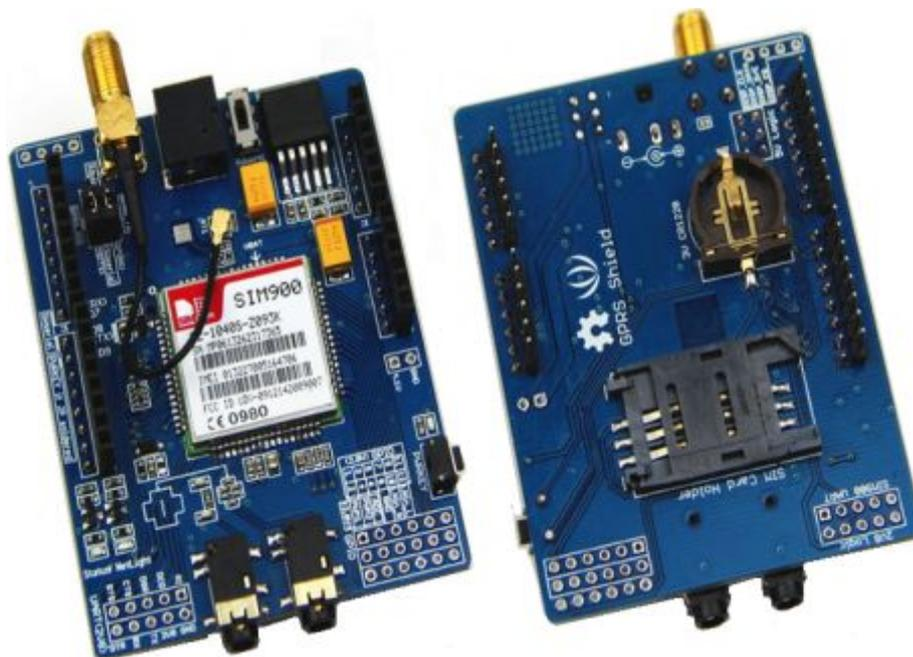
**Figura 27.-** Arduino Shield GSM/GPRS Sim900.
