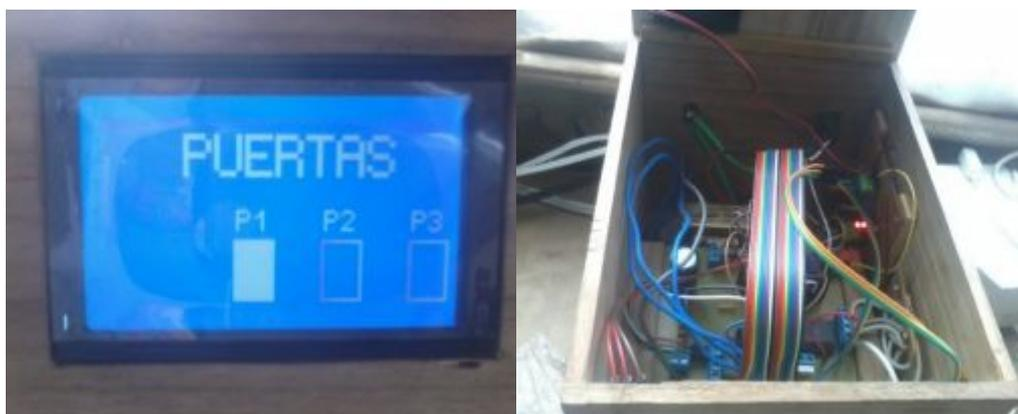
**Figura 92.-** Módulo GLCD y Microcontrolador PIC 16F877A.
