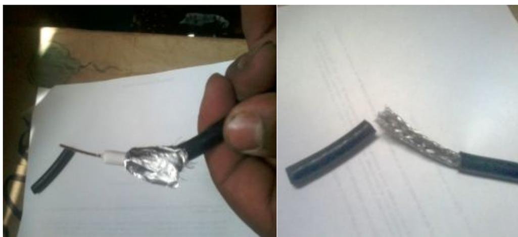
**Figura 59.-** Cable Coaxial para Audio y Video.
