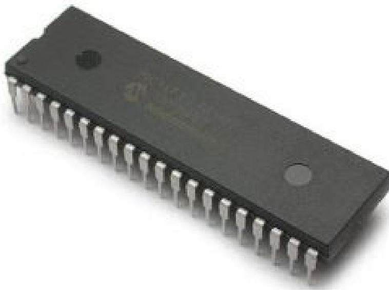
**Figura 30.-** Microcontrolador PIC 16F877A.
