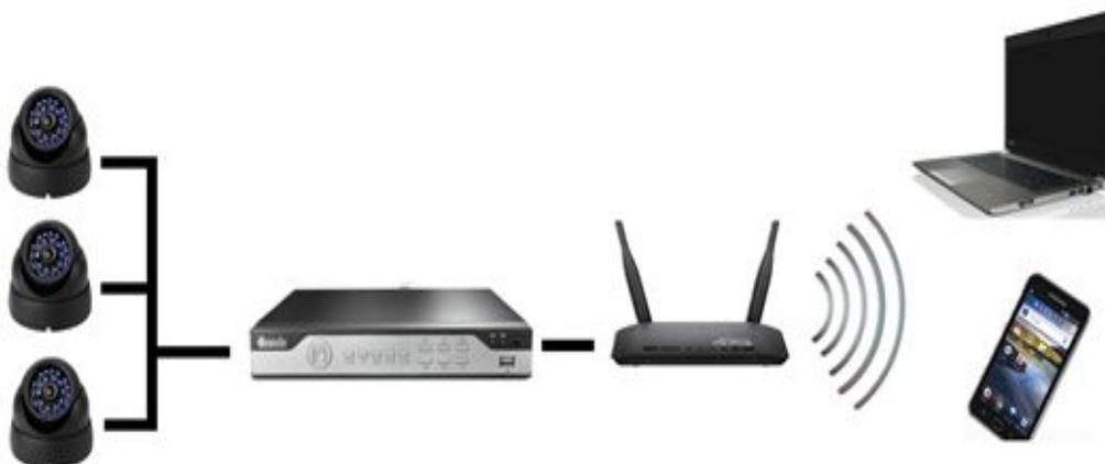
**Figura 57.-** Conexión de 3 Cámaras, DVR, Router a una Portátil o Celular.
