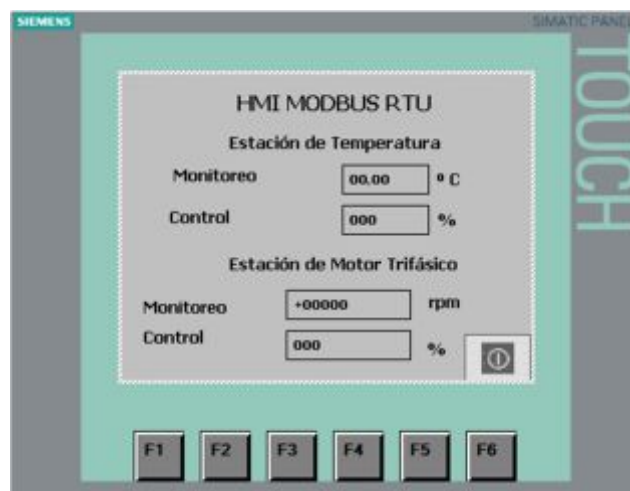
Figura 59 HMI de la red ModBus
