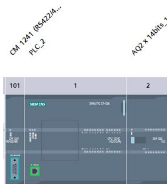
Figura 22 Modulo SM 1232 AQ conectado al PLC_2
