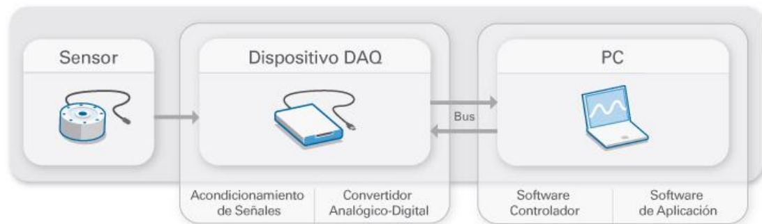
Figura 1 Partes de un sistema DAQ
