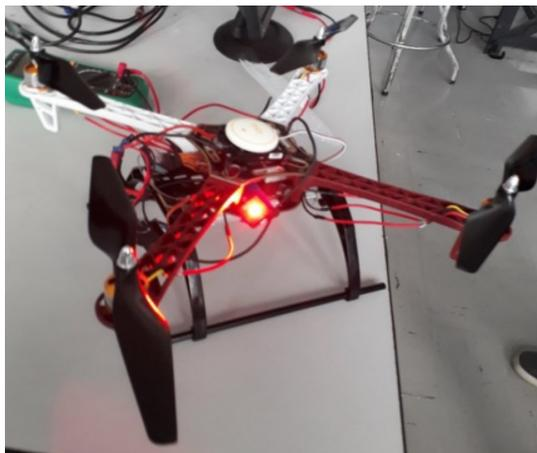
**Figura 32 Colocación de NAZA, ESC**
