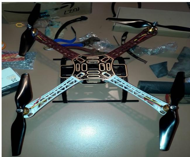
**Figura 31 Colocación de las hélices y motores**
