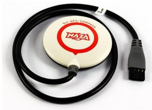
**Figura 26 Módulo compas y GPS**
