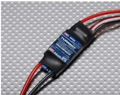
**Figura 22 Controlador de motores brushless 30A**
