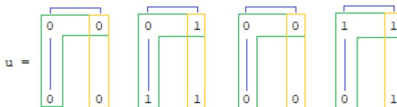
En la Figura 13 se presenta el segundo nivel de profundidad donde se combina 4 bits y se repite los 2 últimos bits. Los 4 bits, señalados con verde en la parte superior, son los bits para operar, los bits señalados con azul y rojo se combina con la operación *XOR* y el producto se ubica en la segunda fila. Los bits señalados con amarillo, corresponde a los bits que se repite.
