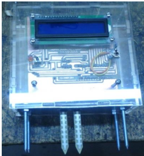
Figura 30. Sensor humedad de suelo inalámbrico.
