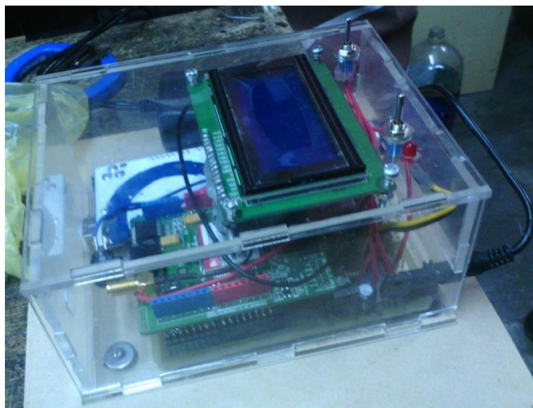
Figura 56. Armado final de la placa principal.
