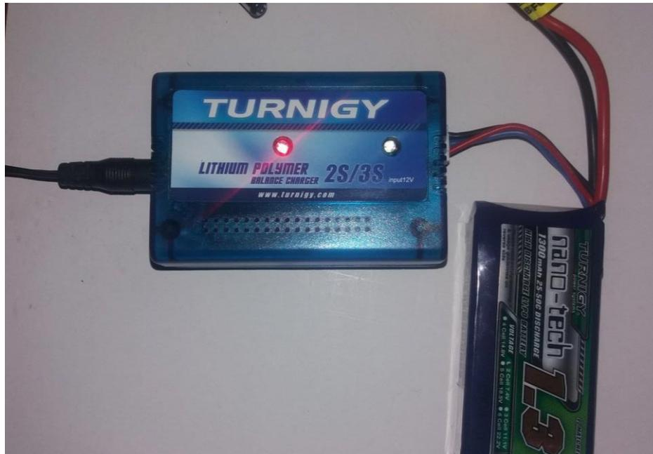
**Figura 57 Carga de Batería LiPo de dos Celdas**
