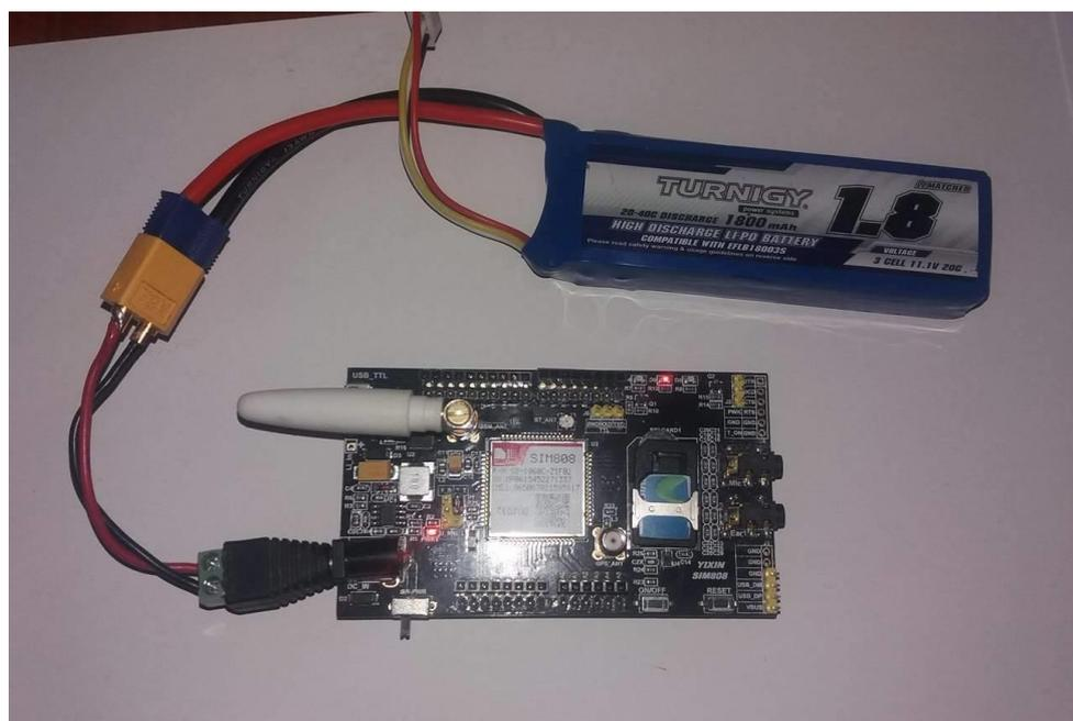
**Figura 56 Conexión Batería al Módulo Shield YIXIN SIM808**
