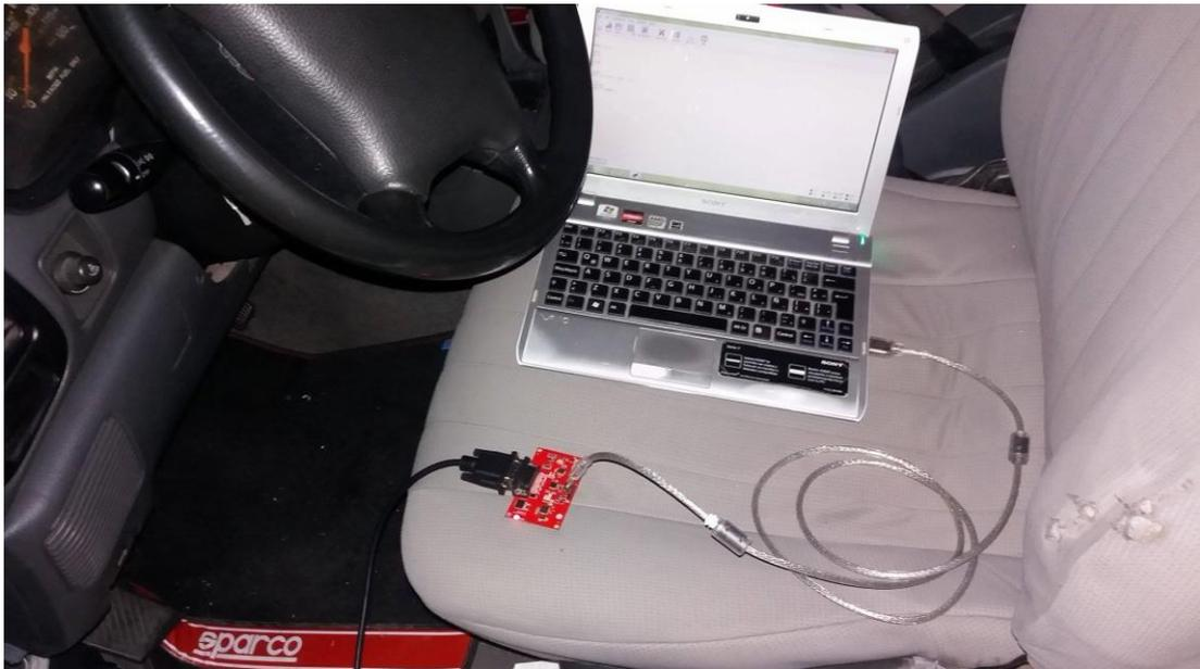
**Figura 35 Conexión OBD del vehículo a la PC**
