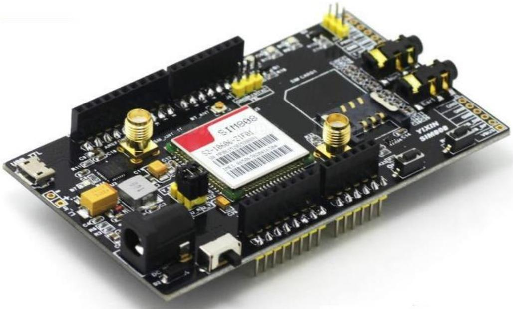
**Figura 20 Módulo GPS/GSM/GPRS YIXIN SIM808**
