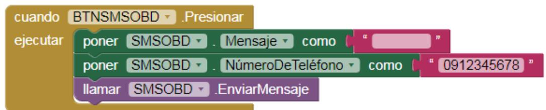
**Figura 51 Estructura para Enviar SMS**
