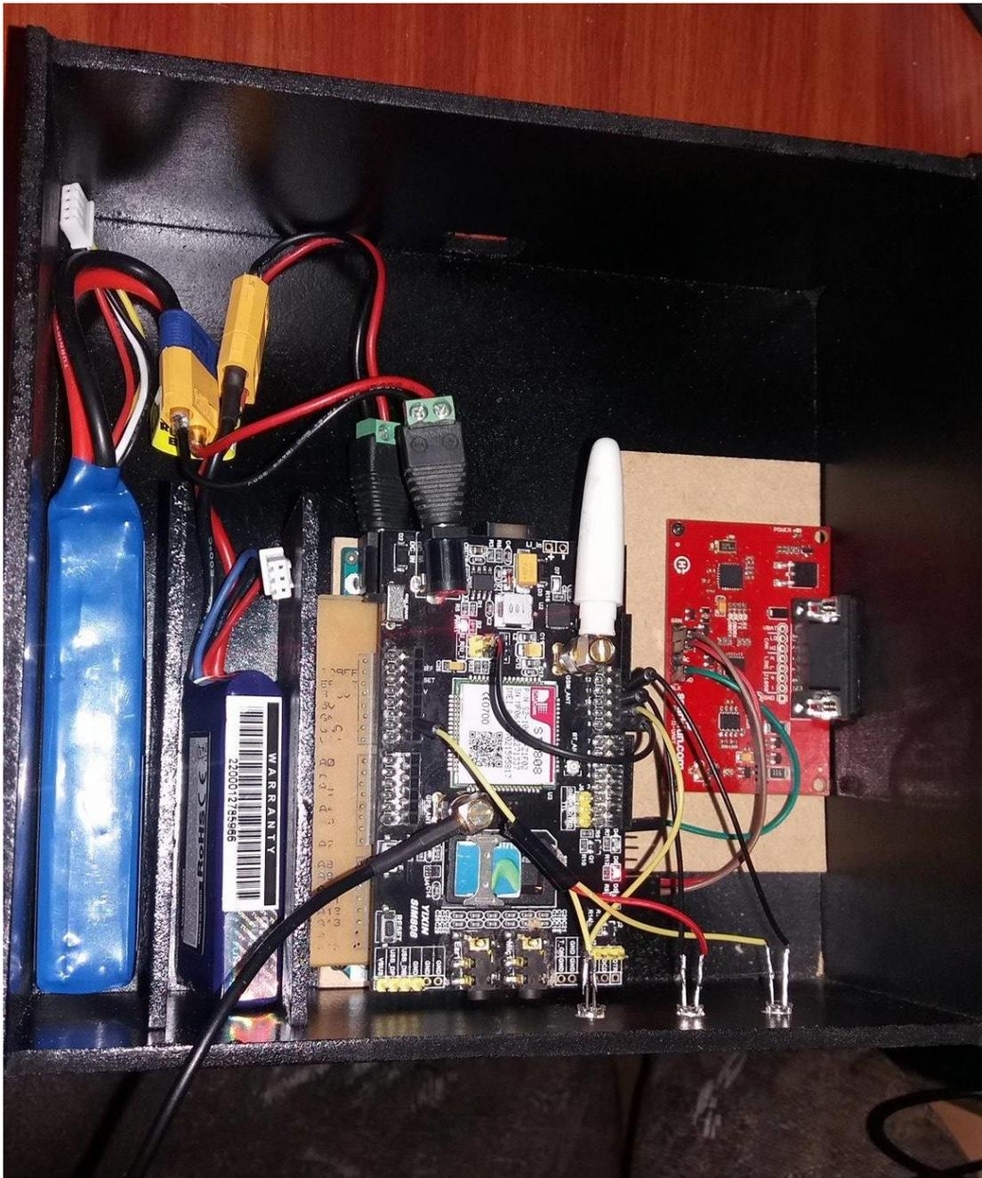
**Figura 60 Conexión del Módulo GPS - OBD**
