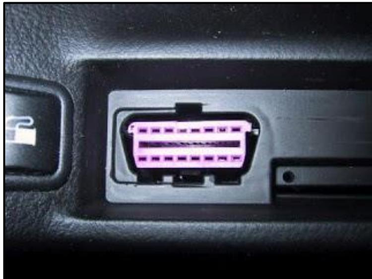
**Figura 14 Conector OBD II Hembra**
