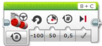
**Figura 61** Bloque para giro izquierda del robot
