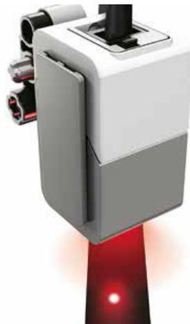
**Figura 18** Sensor de intensidad de luz reflejada
