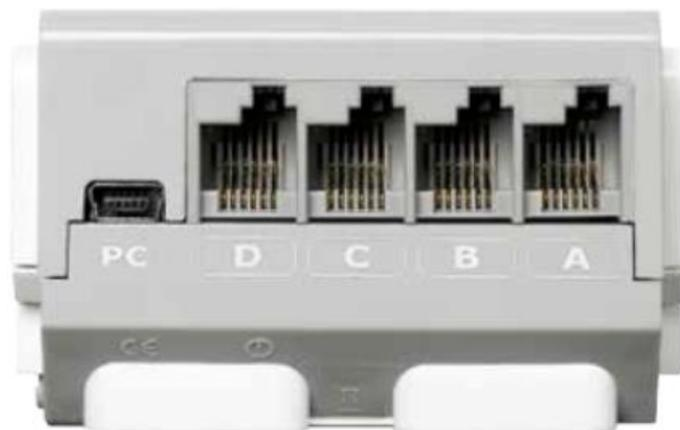
**Figura 11** Puertos de salida y PC del bloque EV3
