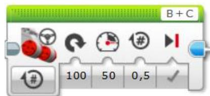
**Figura 63** Bloque para giro a la derecha del robot
