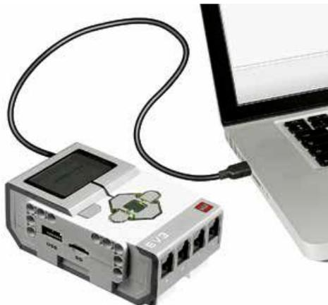
**Figura 34** Conexión del bloque EV3 al computador mediante cable USB
