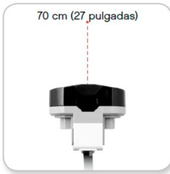
**Figura 21** Sensor infrarrojo en modo proximidad
