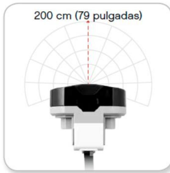
**Figura 22** Sensor infrarrojo en modo baliza
