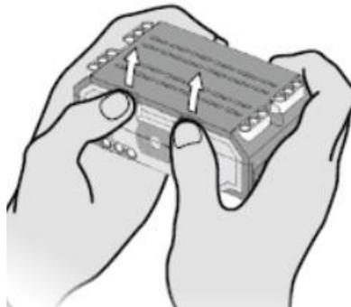
**Figura 31** Apertura de tapa posterior del bloque EV3
