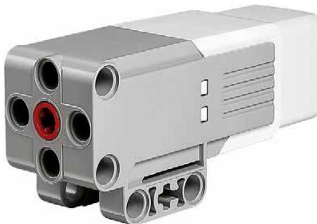
**Figura 16** Motor mediano del bloque EV3
