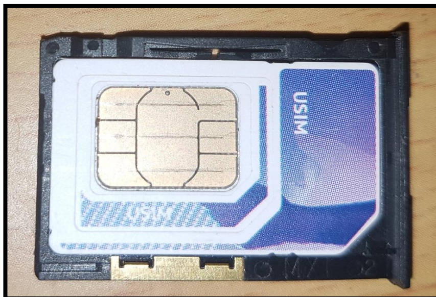
Figura 24 Bandeja de la tarjeta SIM
