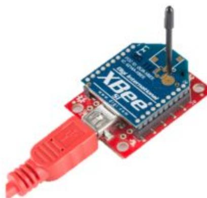
**Figura 28** Conexión Xbee-puerto USB
