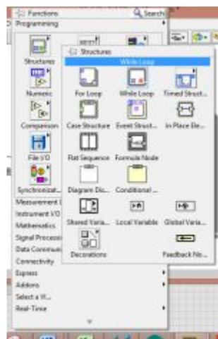
**Figura 36** Ubicación estructura While Loop
