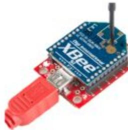
**Figura 18** Conexión Shield Xbee y Xbee S2
