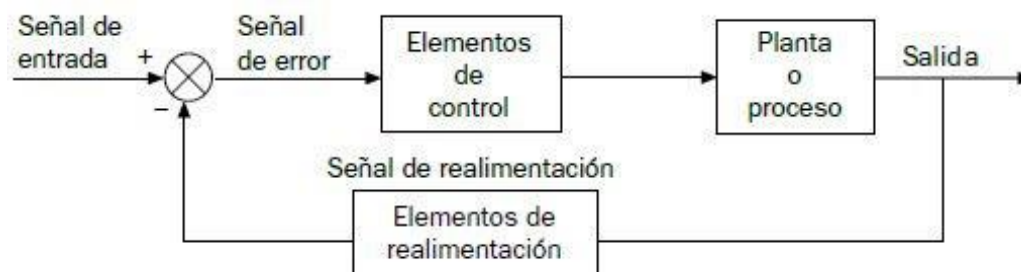
Figura 3 Sistema de control a lazo cerrado
