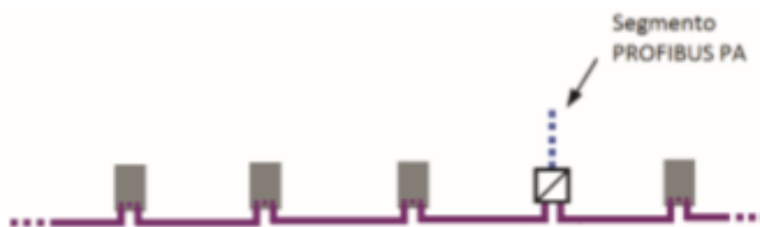
Figura 19 Topología lineal de Profibus DP
