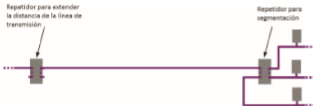
Figura 23 Conexión tipo estrella con un repetidor
