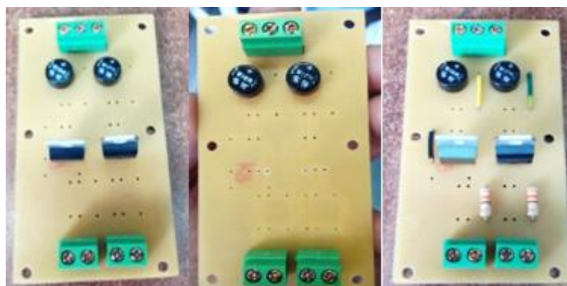
Figura 30 Montaje de los componentes en la placa de la fuente de alimentación
