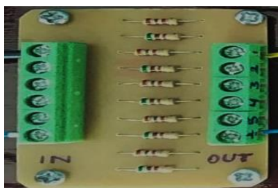
Figura 35 Montaje de los componentes en la placa del módulo divisor de voltaje
