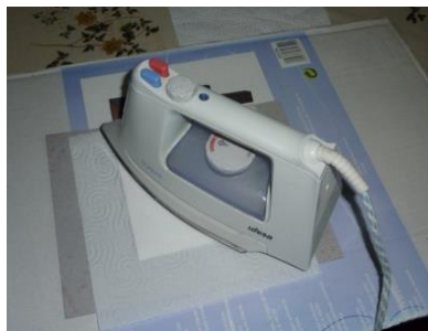
Figura 37 Aplicación de calor para la transferencia de las pistas a la placa de baquelita
