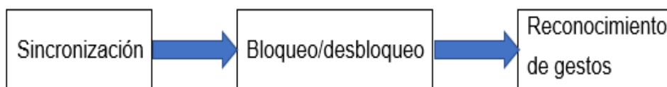
Figura 43 Diagrama de bloques de las etapas para el control de movimiento del brazo robótico
