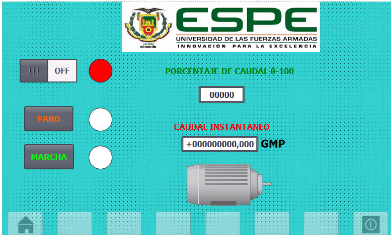
Pantalla de control HMI
