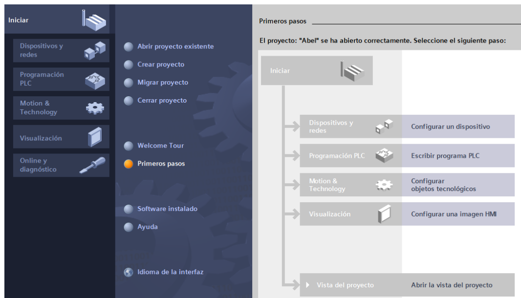
Figura 17 Ventana de configuración del PLC en el software TIA PORTAL
