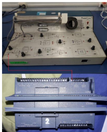
Figura 26 Conexión de Reference Disturbance a AQ2M del PLC.
