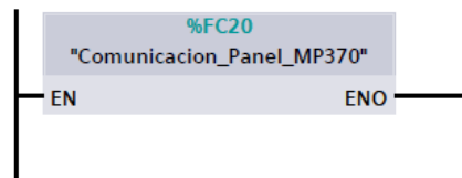
Figura 43. Ejecución de FC20 en programa principal de PLC de Tanque de Construcción
