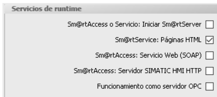
Figura 53. Activación de Sm@rt Service en panel de operador
