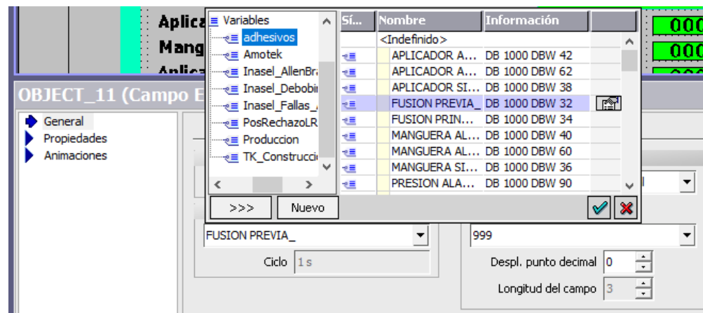
Figura 36. Campo de salida de Tanque de Siliconado
