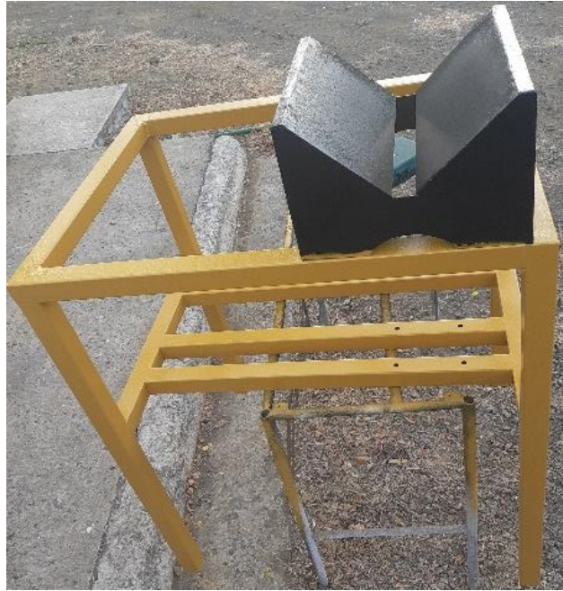
Figura 40 Estructura metálica del banco
