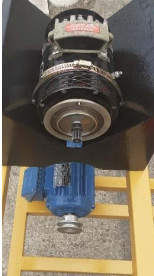
Figura 41 Generador - motor AC
