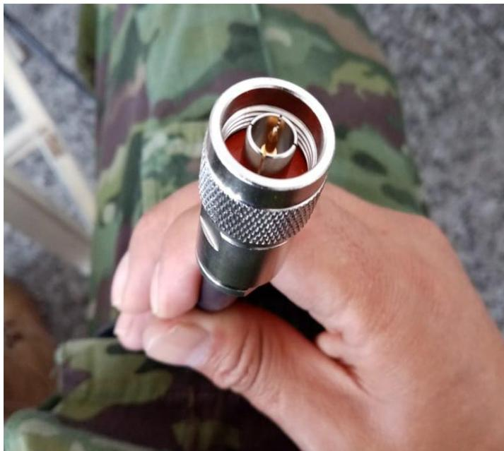
Nota: En la imagen se muestra el conector tipo N macho instalado.
