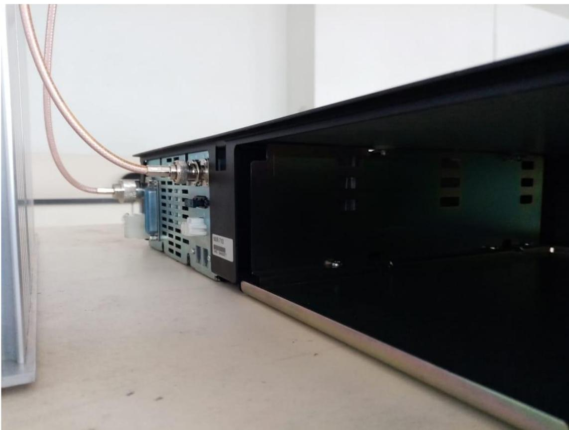
Nota: En la imagen se observa la conexión entre el duplexor y la repetidora.
