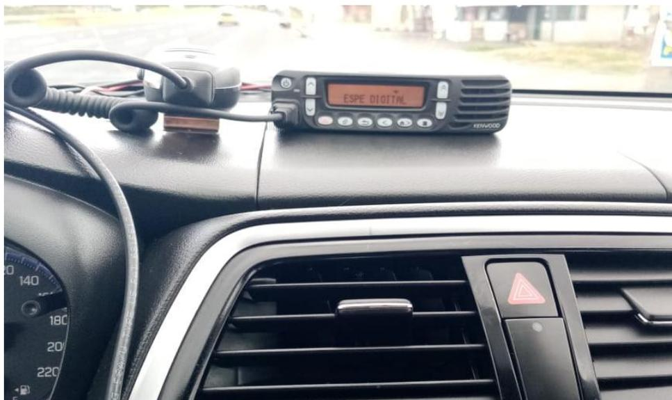
Nota: En la imagen se observa la instalación de la radio vehicular.
