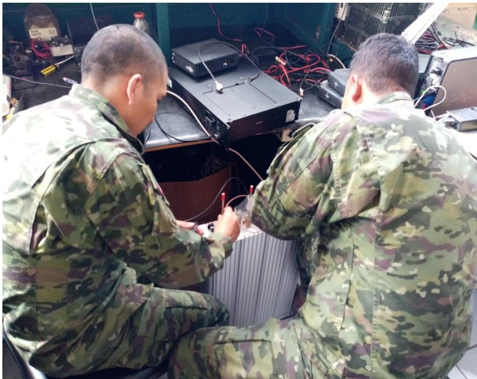
Nota: En la imagen se observa la manipulación de las varillas de paso del duplexor.
