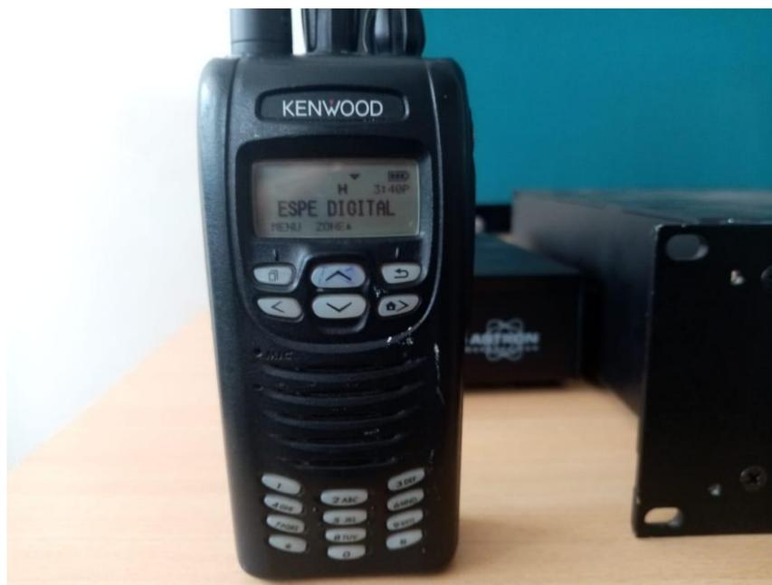
Nota: En la figura se observa la radio portátil en el canal digital.
