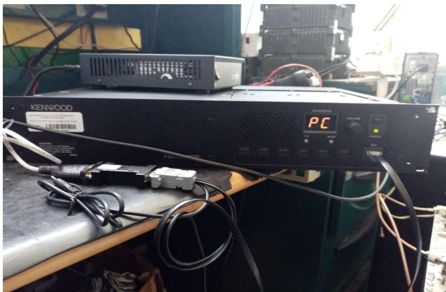
Nota: En la figura se puede observar la conexión entre la repetidora con la computadora.
