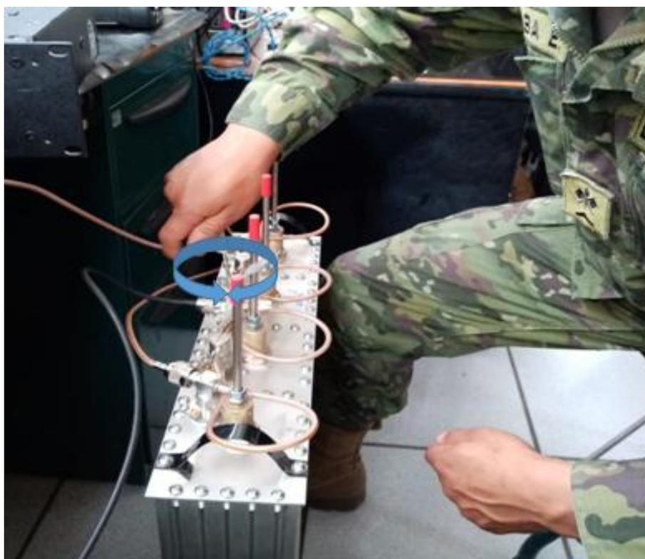
Nota: En la imagen se observa la manipulación de los tornillos de rechazo del duplexor.
