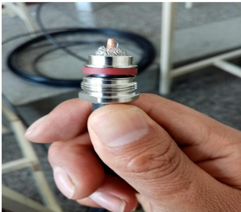
Nota: En la figura se observa la colocación del conector en el cable de bajada de antena.
