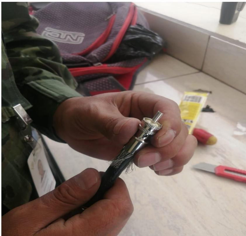
Nota: En la imagen se observa la colocación del conector en el coaxial.
