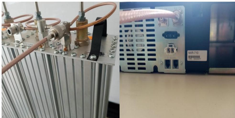
Nota: En la imagen se observa la conexión entre el duplexor y la repetidora.
