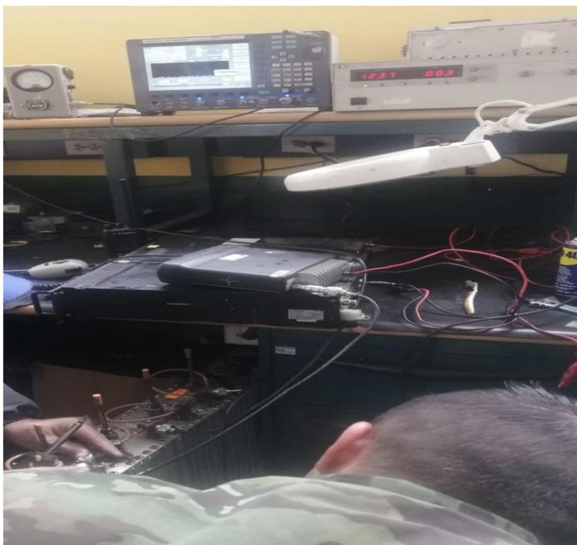
Nota: En la figura se observa la manipulación de los tornillos de rechazo del duplexor.
