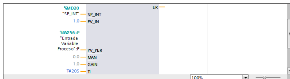
Figura 30. Ingreso de la Variable %MD20 al bloque PID.
