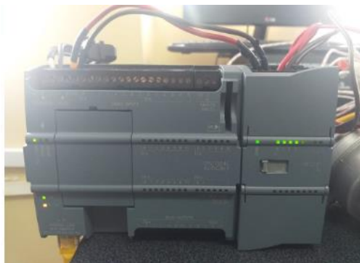
Figura 114. PLC S7-1200 y módulo de entradas análogas
