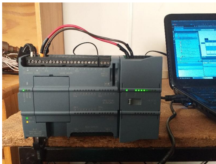
Figura 65. Estados de los LEDs del módulo análogo y el PLC
