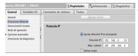
Asignar diferentes direcciones IP para cada PLC MAESTRO (192.168.0.11) y PLC ESCLAVO (192.168.0.10).
