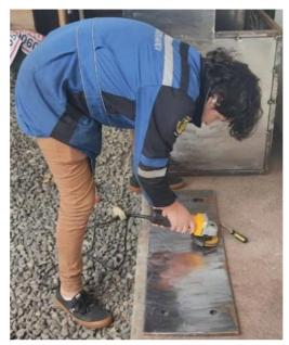
*Nota*. En la figura se muestra el pulimiento del panel de control, este proceso se realiza para todo el banco.
