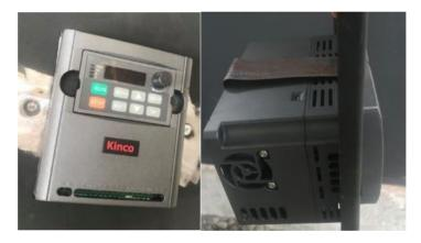
Nota. Colocación del variador de frecuencia con el soporte metálico en el panel de control del banco.
