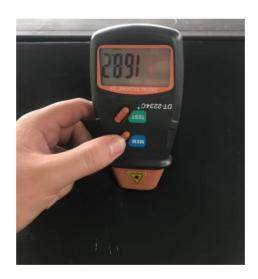
Nota. En la figura se observa una medición media de la velocidad del alternador.
