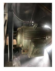
Nota. En la figura se puede observar cómo se encuentran conectados el motor y la banda de transmisión de movimiento.
