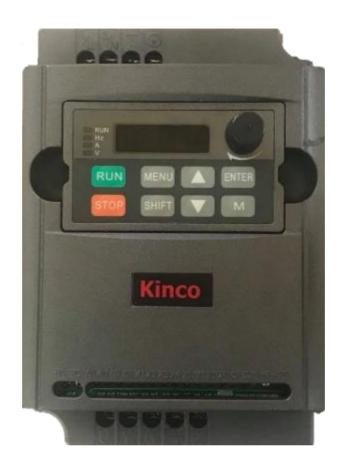
*Nota.* Parte delantera del variador de frecuencia Kinco CV100 el cual es utilizado en este proyecto.
