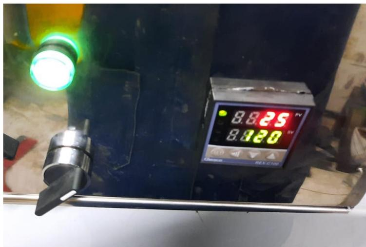
*Nota.* El gráfico representa el control de mandos del sistema de temperatura ubicado en el panel de operación del túnel termoencogible.
