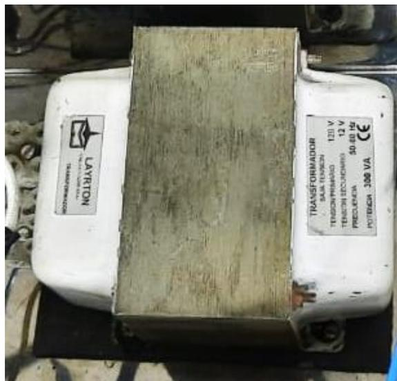
*Nota.* El gráfico muestra un transformador de baja tensión de 120V AC a 12V AC, frecuencia de 50-60Hz y potencia de 300VA.
