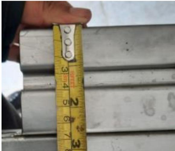
*Nota.* El gráfico muestra la estructura de la base de la banda transportadora para colocar las guías realizadas a la medida de 1,5cm en la parte superior y de 1cm en la parte inferior.
