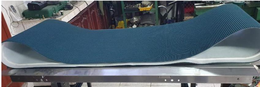
*Nota.* El gráfico muestra a la cinta transportadora utilizada en el túnel termoencogible con su respectiva guía.
