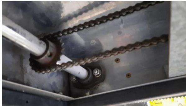
*Nota.* El gráfico muestra el acople del eje motriz de los rodillos al eje del motor de la banda transportadora mediante cadena.
