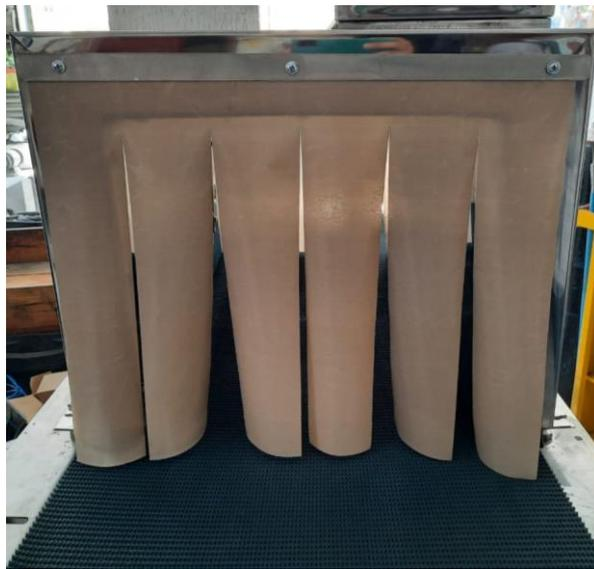
*Nota.* El gráfico muestra la instalación del material termo-resistente en forma de cortina en la entrada y salida del túnel termoencogible para retener el calor y proteger el interior.
