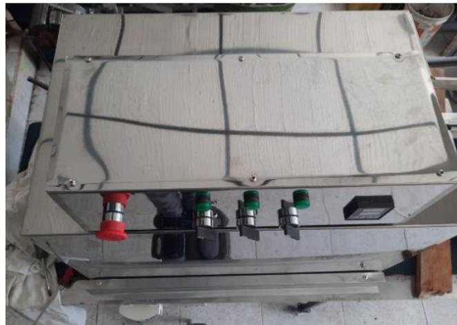
*Nota.* El gráfico muestra el panel del operador de los sistemas del túnel termoencogible con los componentes ubicados en el interior de la caja de protección.
