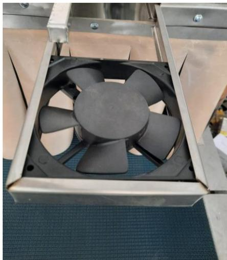
*Nota.* El gráfico muestra la instalación del sistema de ventilación a la salida del túnel termoencogible en su parte superior.
