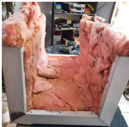
*Nota.* La figura muestra el relleno interior del túnel termoencogible con lana de vidrio.
