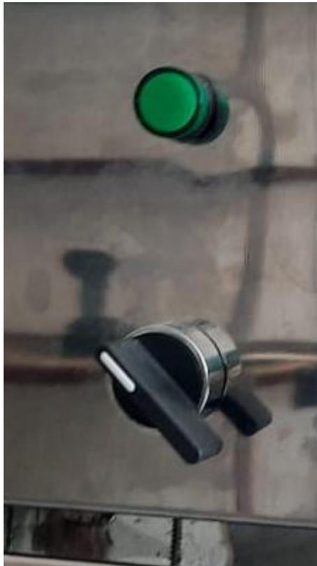
*Nota.* El gráfico muestra el control de mandos del sistema de banda transportadora ubicado en el panel de operación del túnel termoencogible.
