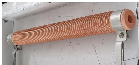
*Nota.* La figura representa a una resistencia cerámica de calentamiento tipo tubular de 25cm de largo, con una alimentación de 220V AC. Temperatura MAX. 600°C.
