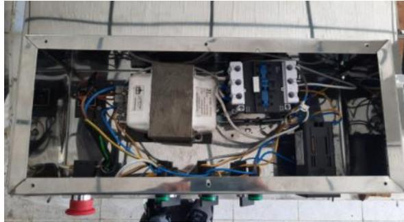
*Nota.* El gráfico muestra la conexión entre todos los componentes del sistema del túnel termoencogible montados en la parte superior.
