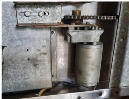
*Nota.* El gráfico muestra el acoplamiento del motor a la base de la banda transportadora y su acople mediante cadena hacia el eje motriz.
