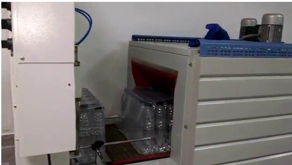
*Nota.* El gráfico representa el proceso de empaque de botellas mediante el proceso de termoencogido con el uso de material termoencogible a través de un túnel termoencogible. Tomado de (S.A.S, 2015)
