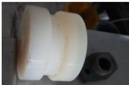
*Nota.* El gráfico muestra los rodillos de acople de la cinta transportadora en PVC.
