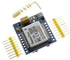
Nota. Se comunica mediante interfaz UART y es compatible con Arduino, Rasperry
