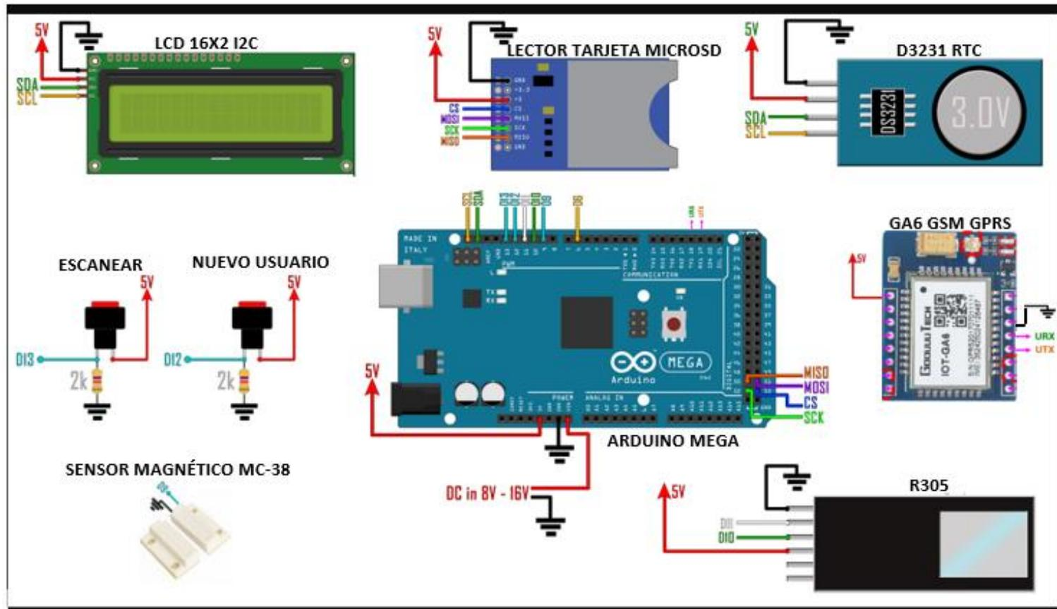
Nota. Diagrama para la conexión de los módulos con el Arduino mega
