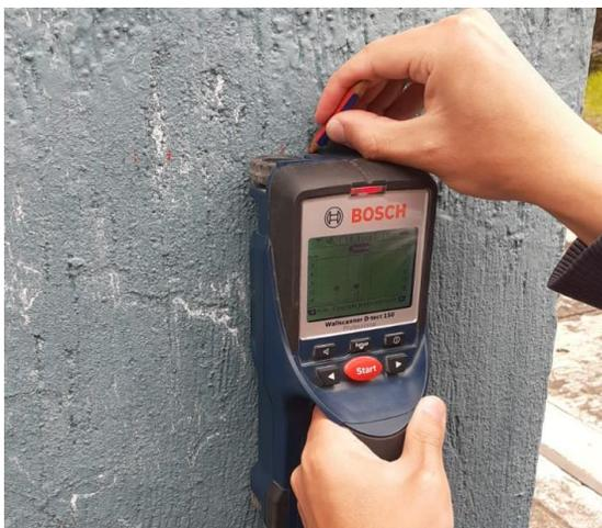
De esta manera se registra la ubicación, diámetro, profundidad y cantidad del armado longitudinal y transversal para su posterior comparación con los planos estructurales.
