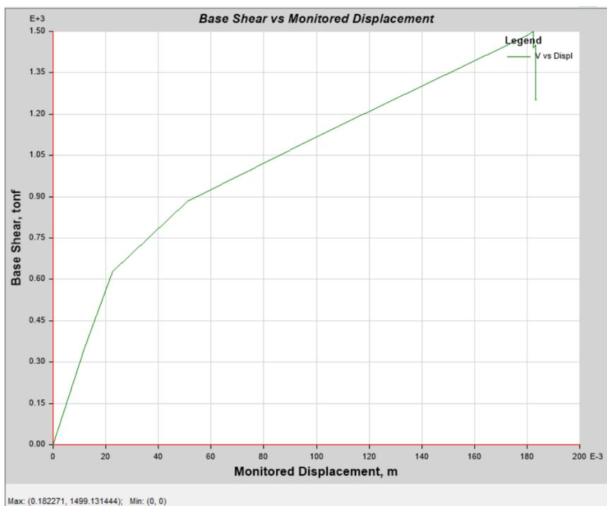
En la Figura 212, se puede apreciar para la curva del espectro aceleración-demanda que existe un punto de desempeño cuando el cortante es de 1344,69 tonf con un desplazamiento de 14,94 cm.
