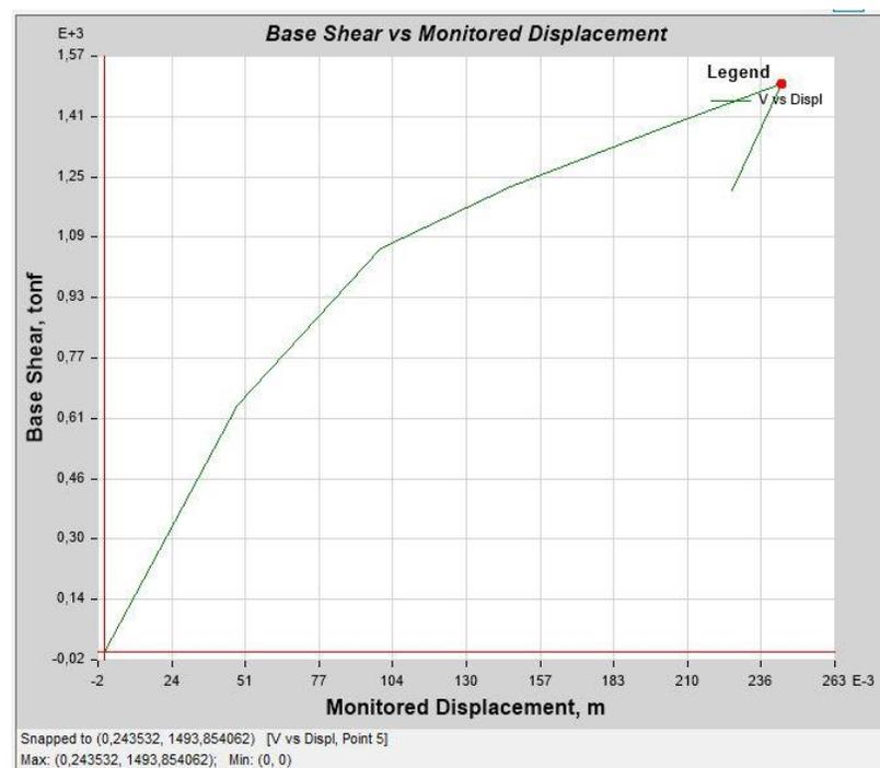
En la Figura 182, se puede apreciar para la curva del espectro aceleración-demanda que existe un punto de desempeño cuando el cortante es de 1493,83 *tonf* con un desplazamiento de 24cm.
