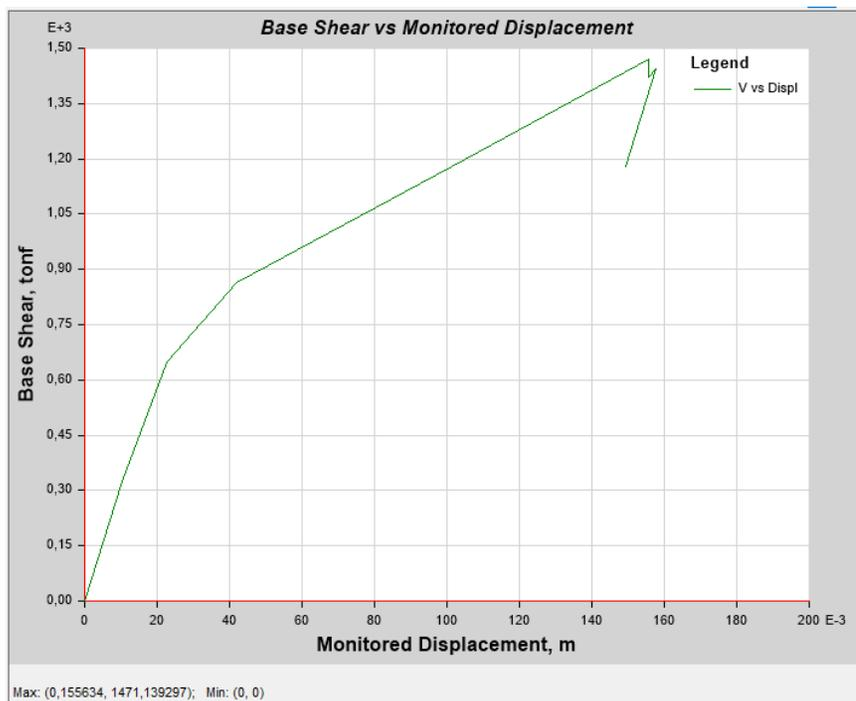
En la Figura 215, se puede apreciar para la curva del espectro aceleración-demanda que existe un punto de desempeño cuando el cortante es de 1469,937 *tonf* con un desplazamiento de 15,56 *cm*.
