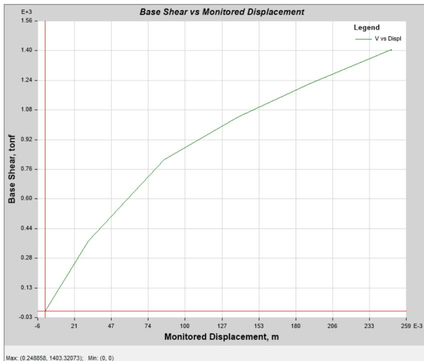
En la Figura 188, se puede apreciar para la curva del espectro aceleración-demanda que existe un punto de desempeño cuando el cortante es de 1304,94 *tonf* con un desplazamiento de 21,74 *cm*.
