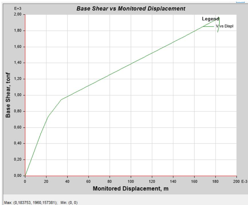
En la Figura 203, se puede apreciar para la curva del espectro aceleración-demanda que existe un punto de desempeño cuando el cortante es de 1646,063 *tonf* con un desplazamiento de 13,81 *cm*.
