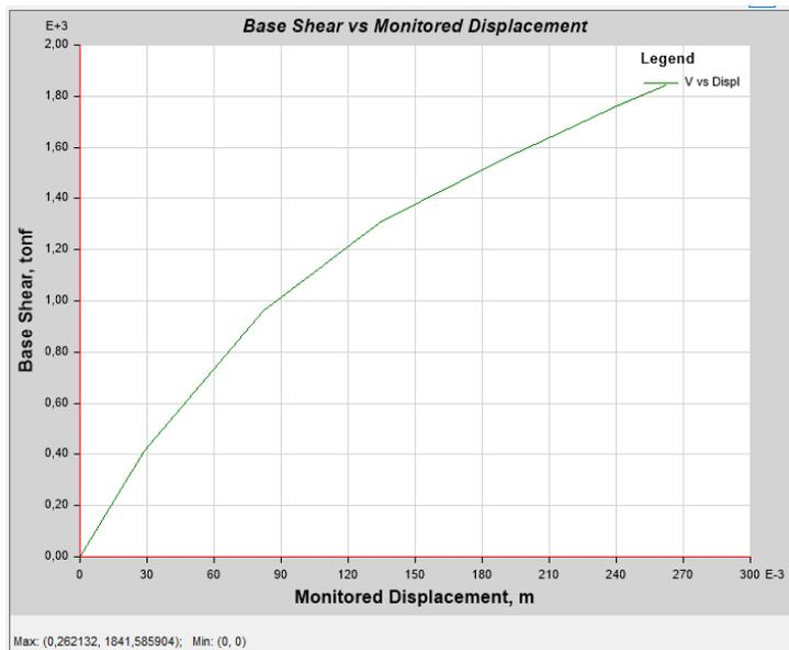
En la Figura 179, se puede apreciar para la curva del espectro aceleración-demanda que existe un punto de desempeño cuando el cortante es de 1623,93 *tonf* con un desplazamiento de 20,67 *cm*.
