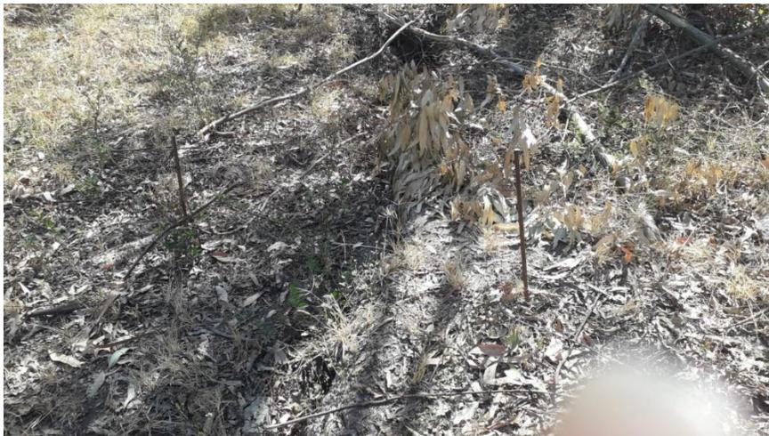
El método consiste en dos varillas empotradas en la tierra, en donde se identifique una grieta en el suelo, en base a esto tomar la medida inicial y después de varios días tomar la medida de final. Se utiliza después la siguiente ecuación.
