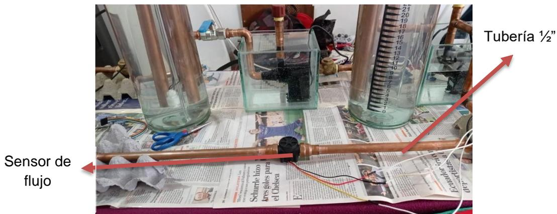
*Nota.* La figura muestra el sensor de flujo instalado en el sistema.
