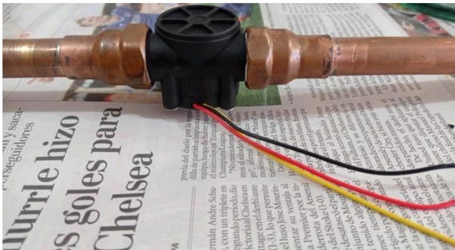
*Nota.* La figura muestra el sensor de flujo instalado en la tubería.
