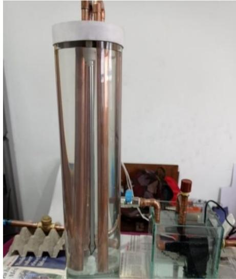
*Nota.* La figura muestra la conexión de la tubería al reservorio de agua que contiene el sensor ultrasónico.
