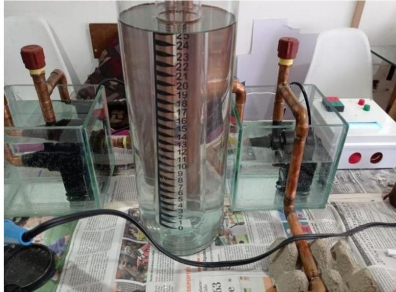
*Nota.* La figura muestra la conexión de la tubería al reservorio de agua que contiene el sensor ultrasónico.
