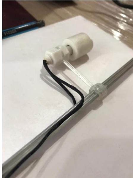
*Nota.* La figura muestra la conexión del sensor tipo flotador a la base que lo sostendrá.
