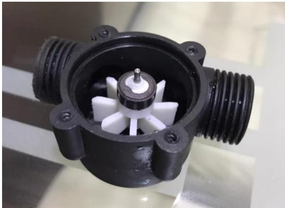
*Nota.* La figura muestra la parte interna de un sensor de flujo.
