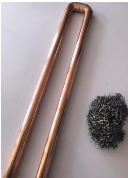
*Nota.* La figura muestra la limpieza que se realizó a la tubería.
