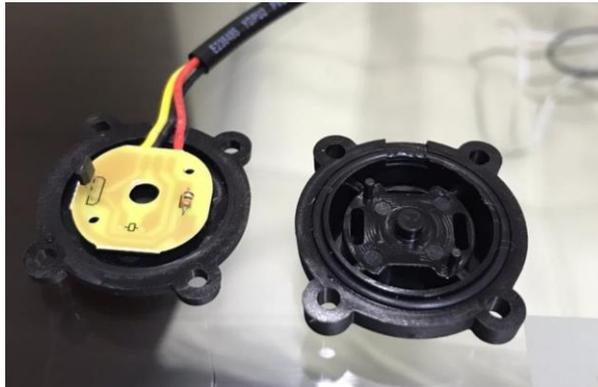
*Nota.* La figura muestra la parte interna de un sensor de flujo.
