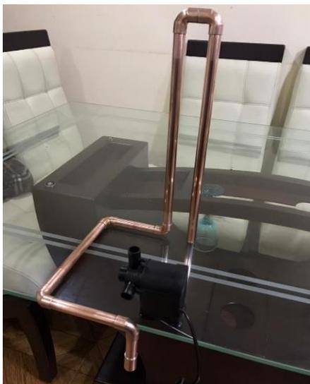
*Nota.* La figura muestra la comprobación de fugas realizada.
