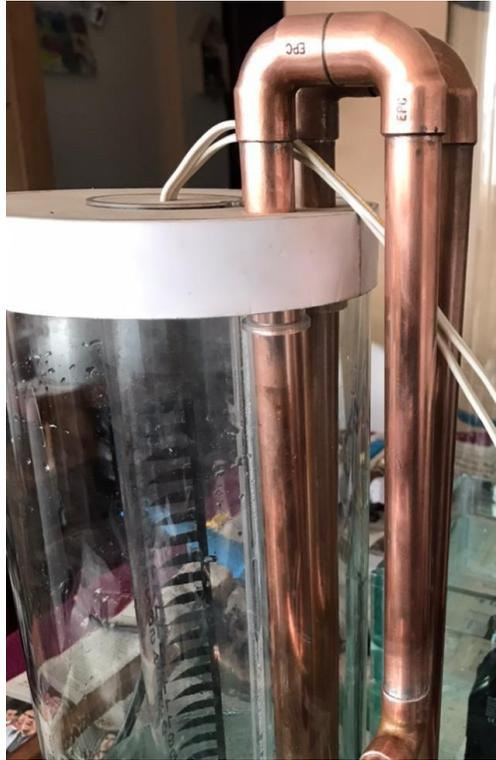
*Nota.* La figura muestra la conexión de la tubería con el tanque del sensor ultrasónico.
