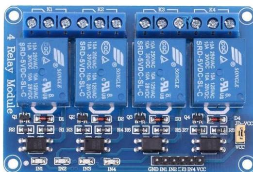
*Nota.* En la imagen se puede observar un módulo relé de 4 canales el cual nos permite conectar hasta 4 dispositivos electrónicos de hasta 220V. Tomado de (Tolocka, 2015)
