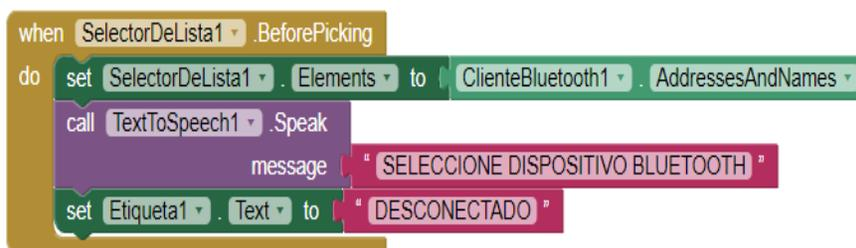
*Nota.* En esta imagen se muestra el diagrama de bloques para elegir el dispositivo bluetooth.
