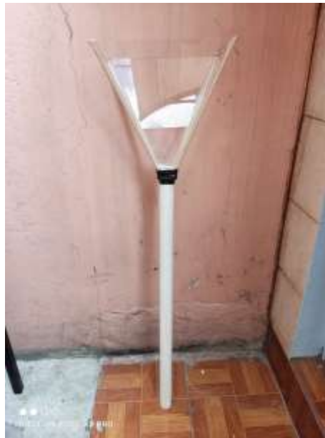
Tolva almacenadora y conducto de salida de comida
